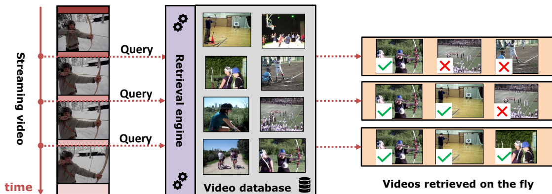
Figure G.2: Notre technique de hachage permet de fouiller à l’intérieur de bases de données vidéo de manière incrémentale, au fur et à mesure du déroulement en direct de la vidéo utilisée comme requête. Un archer est filmé; le flux vidéo est soumis au moteur de recherche, qui retrouve deux résultats corrects sur trois
