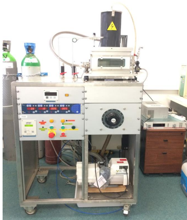
Figure 1 Réacteur à système RF à plasma froid utilisé dans le cadre de Plasma-Bond
