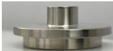
**Figure 7** La géométrie du substrat métallique utilisé pour la procédure laboratoire.
