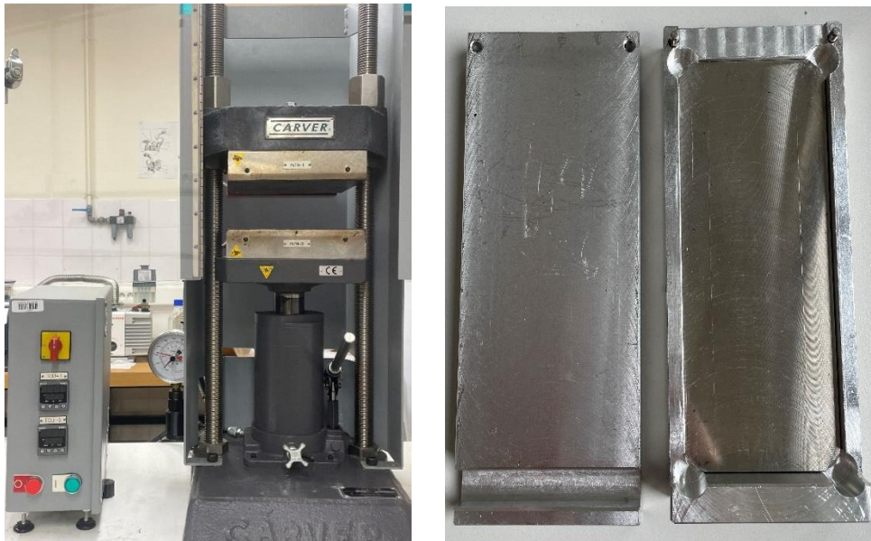
Figure 10 Image de la presse chauffante (gauche) et du moule en aluminium pour la réalisation d'un assemblage Alu - NBR
