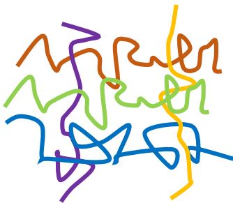
Figure 5 Chaînes macromoléculaires d'un même élastomère cru
