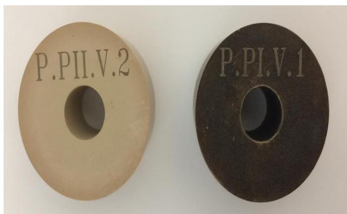
**Figure 14** Image des substrats PTFE (gauche) et PTFE-SA(droite)
