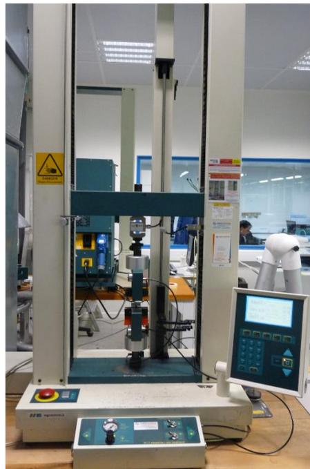
**Figure 12** Système pour les essais de pelage chez Safran
