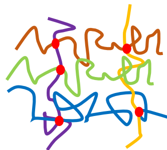
Figure 6 Chaînes macromoléculaires de l'élastomère vulcanisé avec pontage (points rouges) après réticulation
