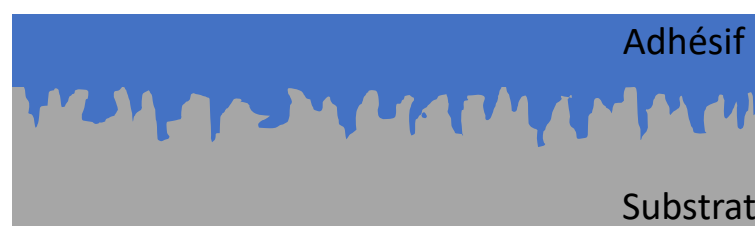
Figure 2 Schéma de l'ancrage mécanique entre le substrat et l'adhésif
