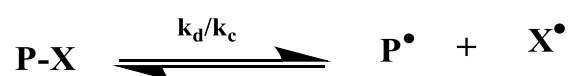
Figure 22 : Equilibre d'activation / désactivation dans la NMP ( k_d et k_c sont les constantes de vitesse de de dissociation et de recombinaison)
