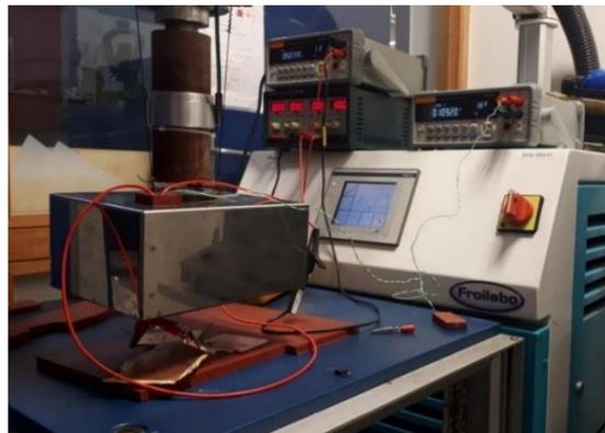
Figure 3.5 Générateur d'air (Froilabo-Dragon III) - Laboratoire SATIE.
