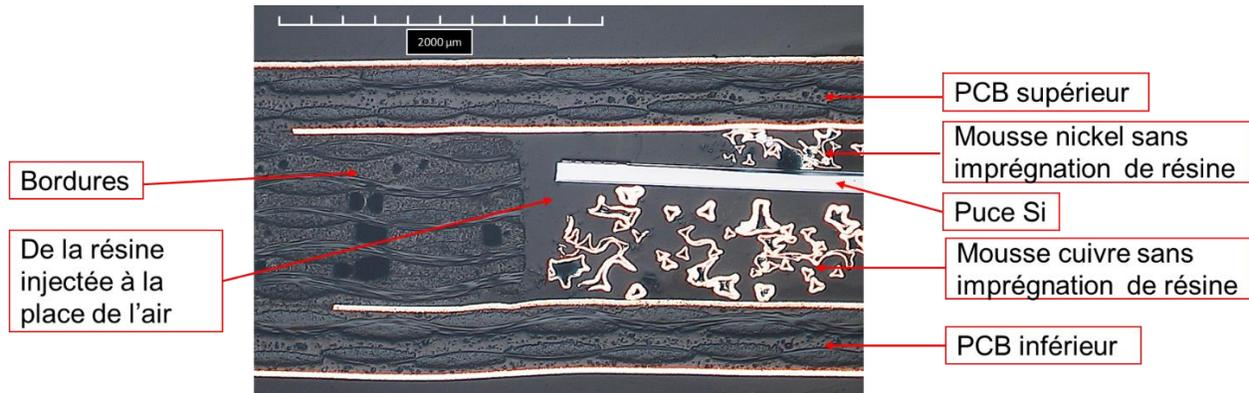
Figure 3.12 Coupe métallographique d'un assemblage  $PCB_{Cu-sans\ résine}^{Ni-sans\ résine}$  intégrant une diode Infineon; contact électrique assuré uniquement par mousse métallique sans imprégnation de résine.
