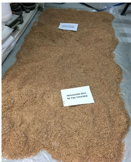
Figure 33 - Granulats végétaux CHMK après prétraitement en cours de séchage.
