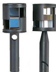
Fig. 9 – L'équerre optique moderne, de face et de côté.
