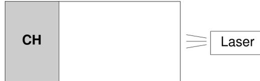
FIGURE 7.1 – Schéma d’une ablation laser : la cible en plastique (en gris) est frappée par le faisceau laser à droite.
