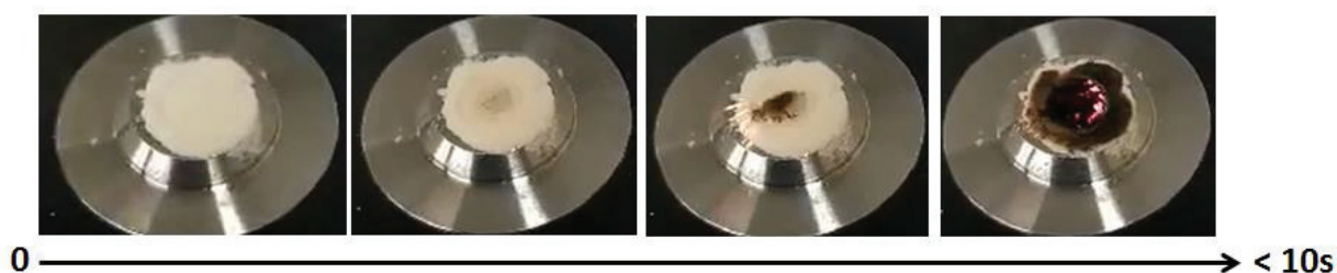
Figure 56 - Décomposition au contact de l'air du matériau Hflr-MAT-A.
