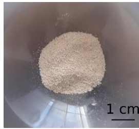
Figure SF-12: Image du matériau réactif CeMS constitué de microsphères de cérine
