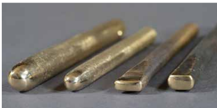
Fig. 252 - Ciselets mats fabriqués lors de l'expérimentation n° 4 - cliché M. Nordez.
