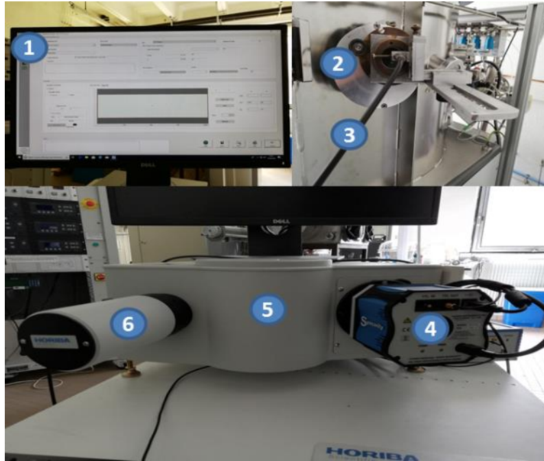
Figure II.27. Composants du spectromètre à émission optique : (1) système d'acquisition et d'analyse de données (SynerJY) ; (2) Hublot en quartz ; (3) Fibre optique ; (4) caméra CCD ; (5) monochromateur Ihr320 ; (6) source de lumière.
