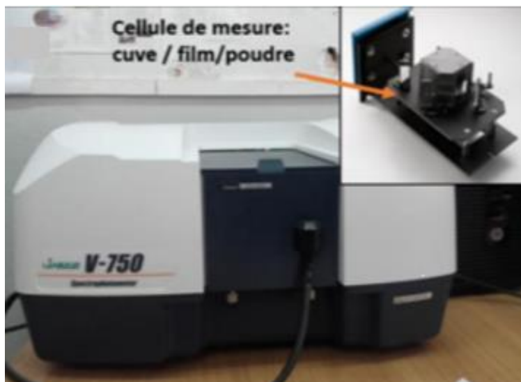
Fig.III.13 Spectrophotomètre UV-Visible de type JASCO V-750
