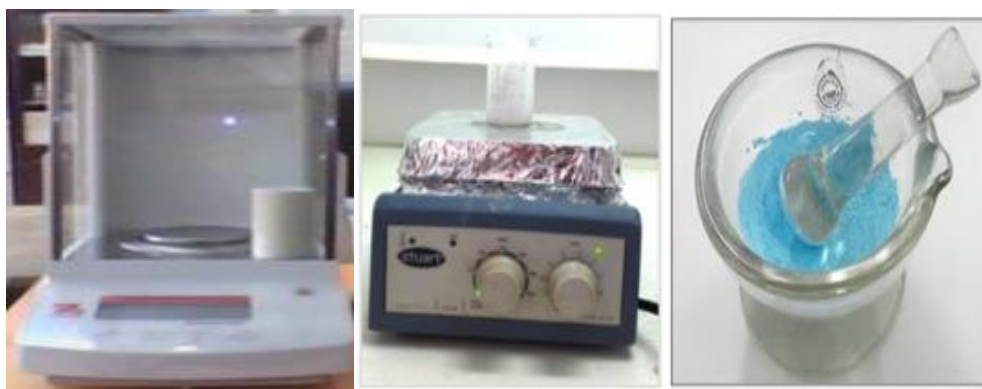
Fig.IV.1 Photographies de : a) balance analytique, b) agitateur magnétique, c) mortier et pilon
