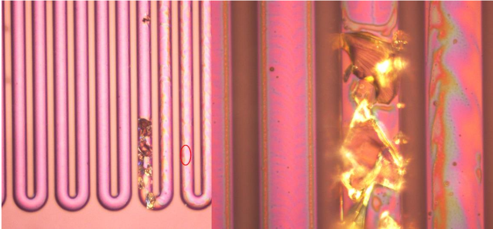
Figure 33 : Photo d'une section d'une micro-colonne dont le dépôt de phase stationnaire a été fait. On observe une obstruction sur l'image de gauche qui correspond à un défaut de fabrication de la colonne. L'image de droite représente un zoom sur l'obstruction. On constate un défaut dans le dépôt de la phase stationnaire sur la colonne après le « bouchon » représenté en rouge/vert.
