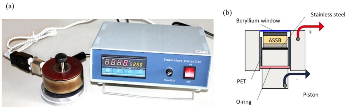
**Figure II.52 :** (a) Moule chauffant utilisée pour le pressage à chaud de batterie tout-solide de 13 mm ; (b) Montage utilisé pour l'operando DRX
