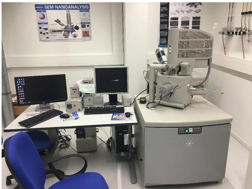
**Figure F** : Microscope électronique à balayage QUANTA 800FEG équipé d'un détecteur EDX SDD (Oxford 80 mm<sup>2</sup>), utilisé au LRCS.
