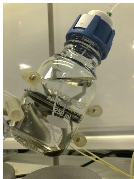
Figure 44. Montage expérimental de partage et de prélèvement des échantillons de forte hydrophilie.
