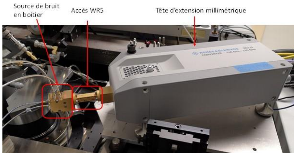
Figure 150 : Photographie d'une partie du banc de test en paramètres S d'une source de bruit amplifiée en boîtier. Le tronçon WR5 a été pris en compte lors de l'étape de calibration en 1 port.
