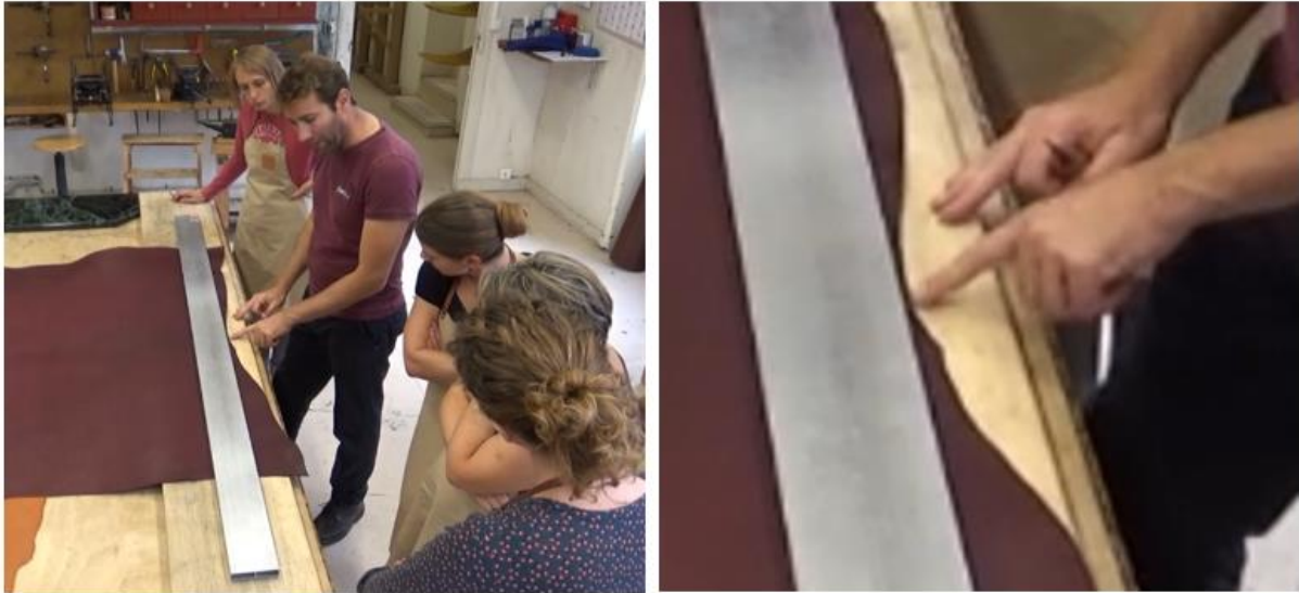
Illustration 13 : Positionnement de la règle métallique
