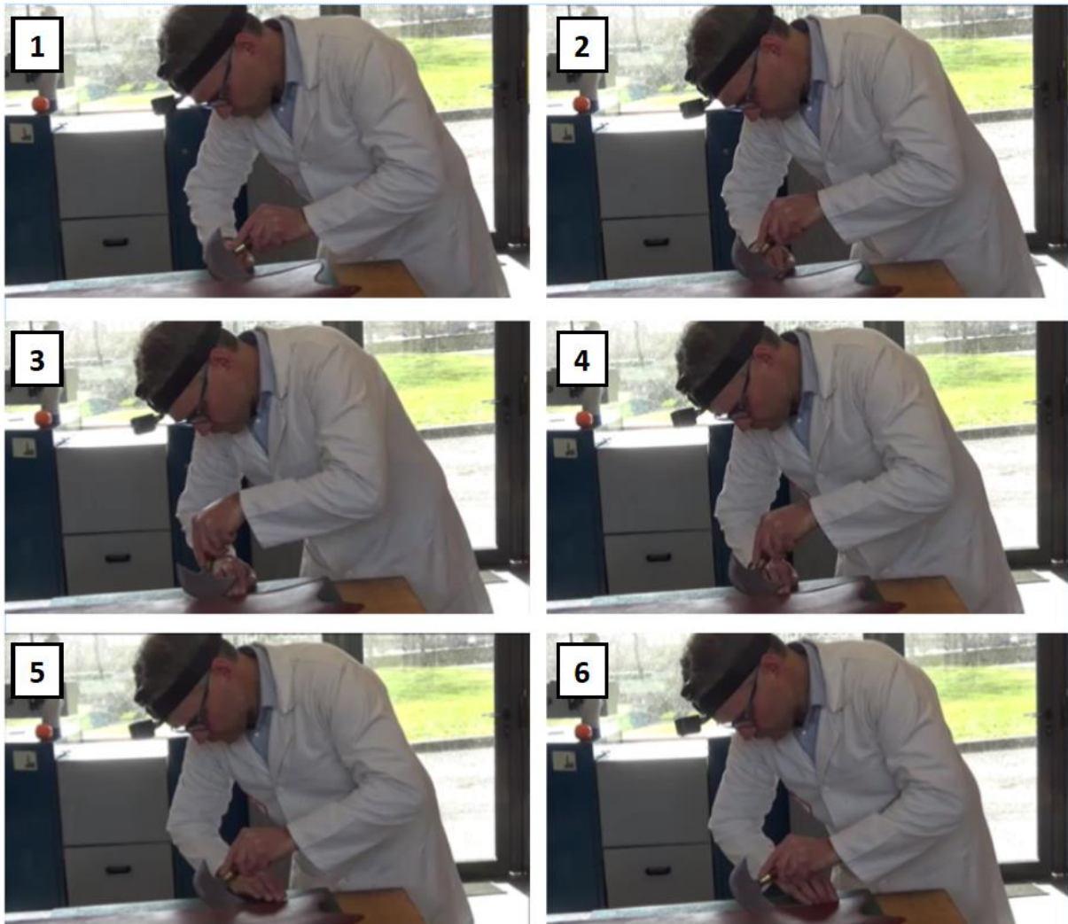
Illustration 18 : Couper en faisant osciller la lame
