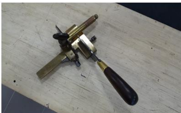
Illustration 14 : Tirer une bande au couteau mécanique
