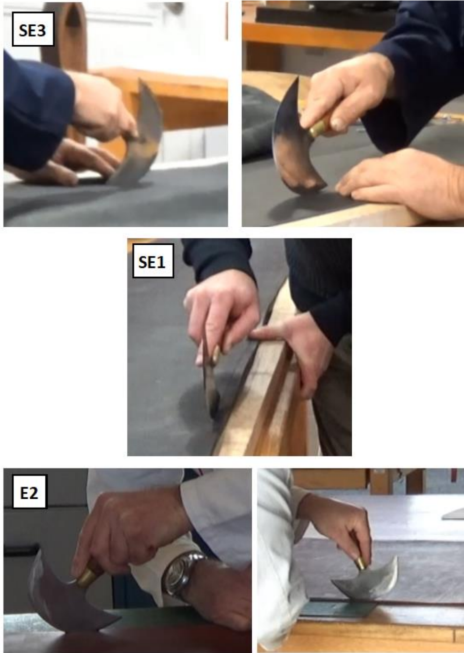
Illustration 28 : Prise en main du couteau à pied par SE3, SE1 et E2
