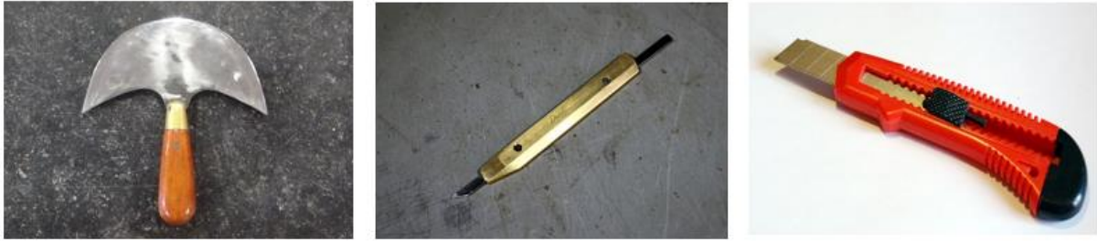
Illustration 15 : Couteau à pied, pointe de coupe et cutter
