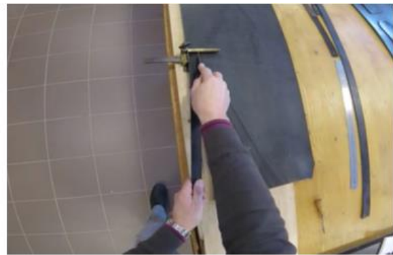
Illustration 14 : Tirer une bande au couteau mécanique
