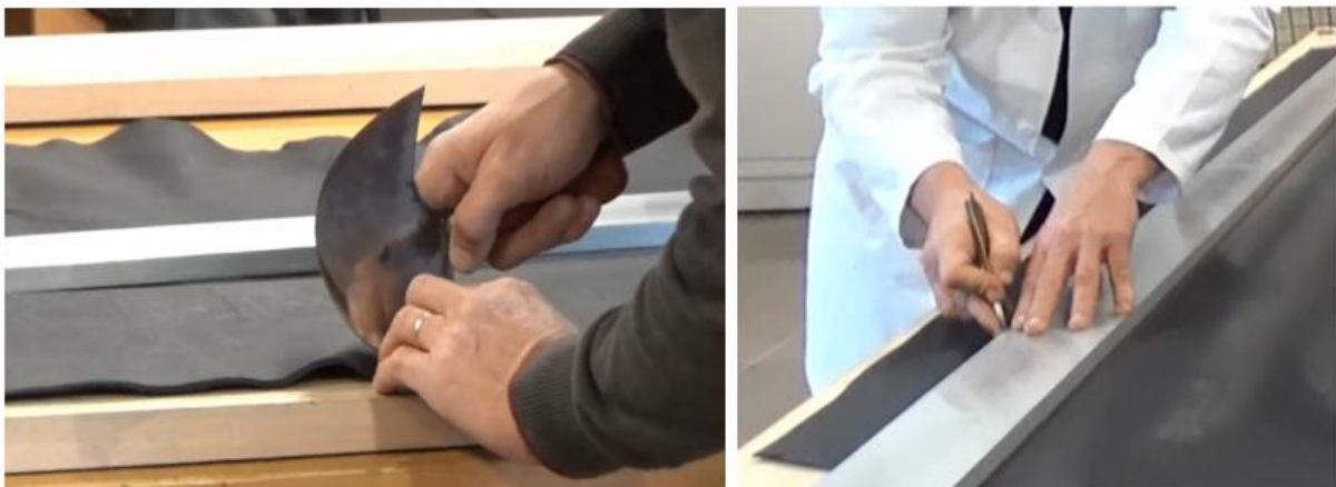
Illustration 22 : Coupe d'un cuir fin et souple au couteau à pied et à la pointe de coupe
