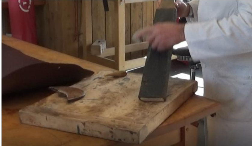
Illustration 29 : Entretien du fil de la lame du couteau à pied
