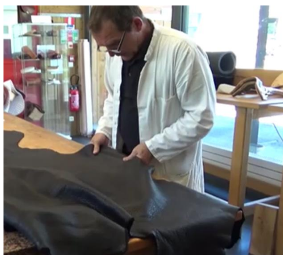
Illustration 9 : SE2 estime le prêtant de la peau pour le siège de la selle
