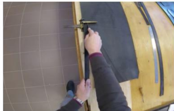
Illustration 14 : Tirer une bande au couteau mécanique
