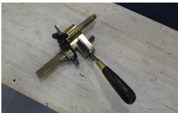
Illustration 14 : Tirer une bande au couteau mécanique
