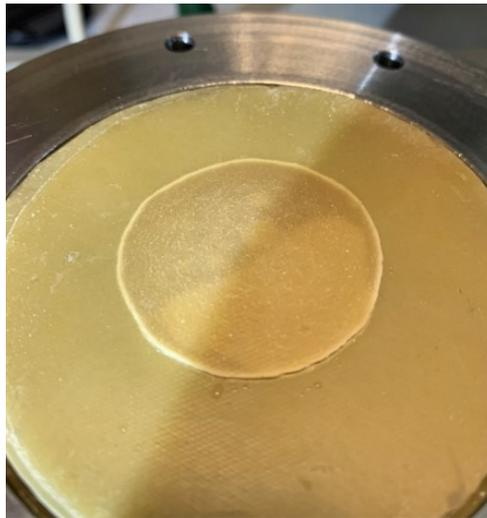
FIGURE 3.4.1 – *Plastification d'un revêtement d'une épaisseur de 1 mm de SAF 30 MIB après un essai de pressurized blister test*
