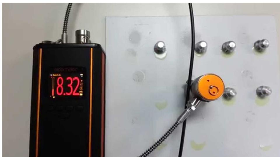
FIGURE 2.6.3 – *Appareil de mesure elcometer 510 relié à des pions de pull-off (source BTM instruments)*
