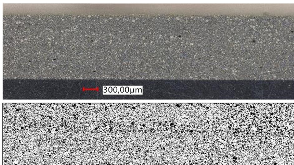
FIGURE 2.4.2 – *Micrographie avant et après seuillage sur un échantillon de l'EA9394® collé sur un substrat en aluminium (épreuve de blister)*
