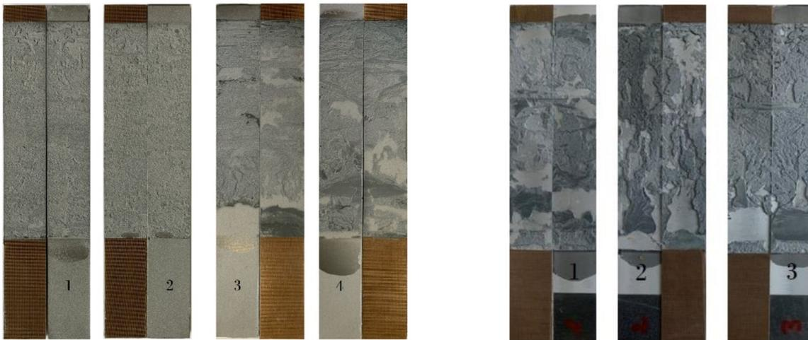
FIGURE 2.7.7 – *Faciès des éprouvettes avec dépôt de primaire (droite) et par traitement de surface laser (gauche) - SW EC-2216©*
