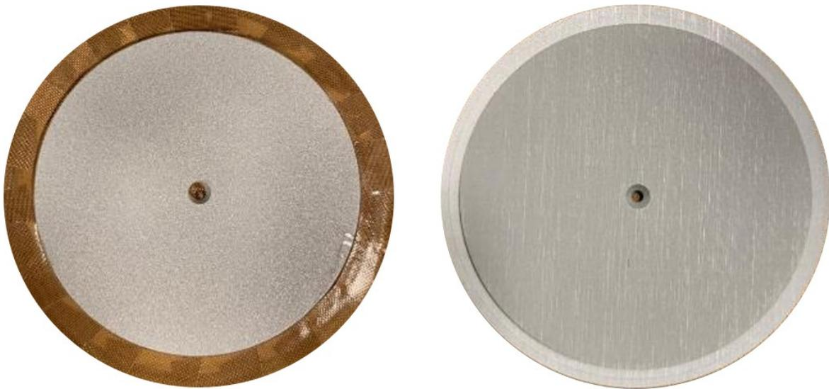
FIGURE 2.1.1 – *Éprouvettes de blister traitées avec primaire d'adhésion (gauche) et laser (droite)*
