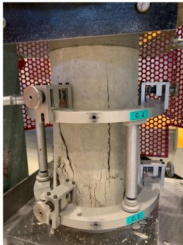
Figure 29. Destruction par compression de l'éprouvette
