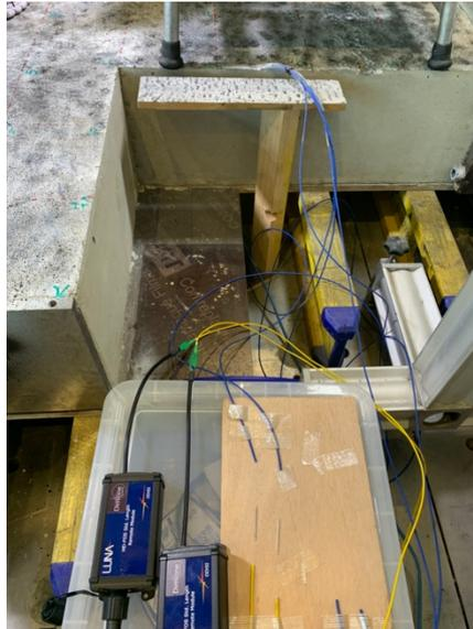
*Figure 47. Sortie des fibres et soudures faites*
