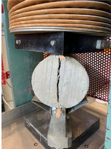
*Figure 33. Destruction par fendage de l'éprouvette*
