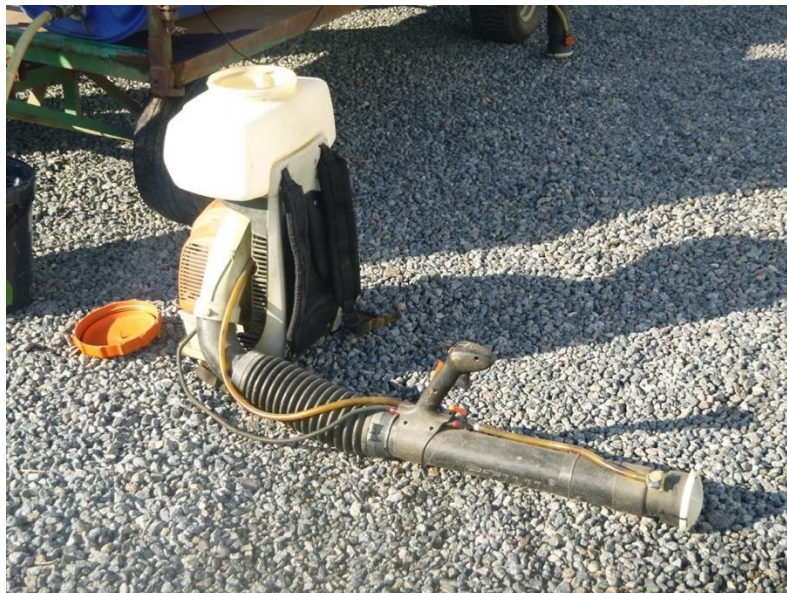
FIGURE 54: ATOMISEUR THERMIQUE UTILISE LORS DES TRAITEMENTS SOUS SERRES – ETUDE PESTEXPO
