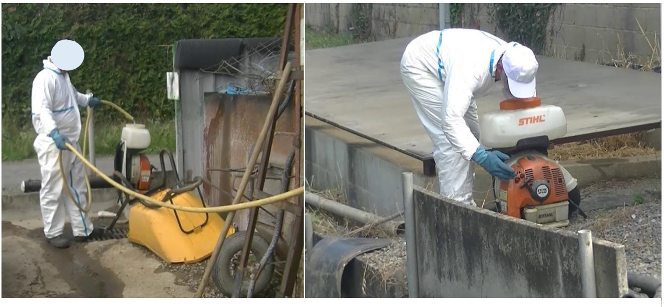
FIGURE 57: NETTOYAGE DE L'ATOMISEUR APRES APPLICATION SOUS SERRE – ETUDE PESTEXPO
