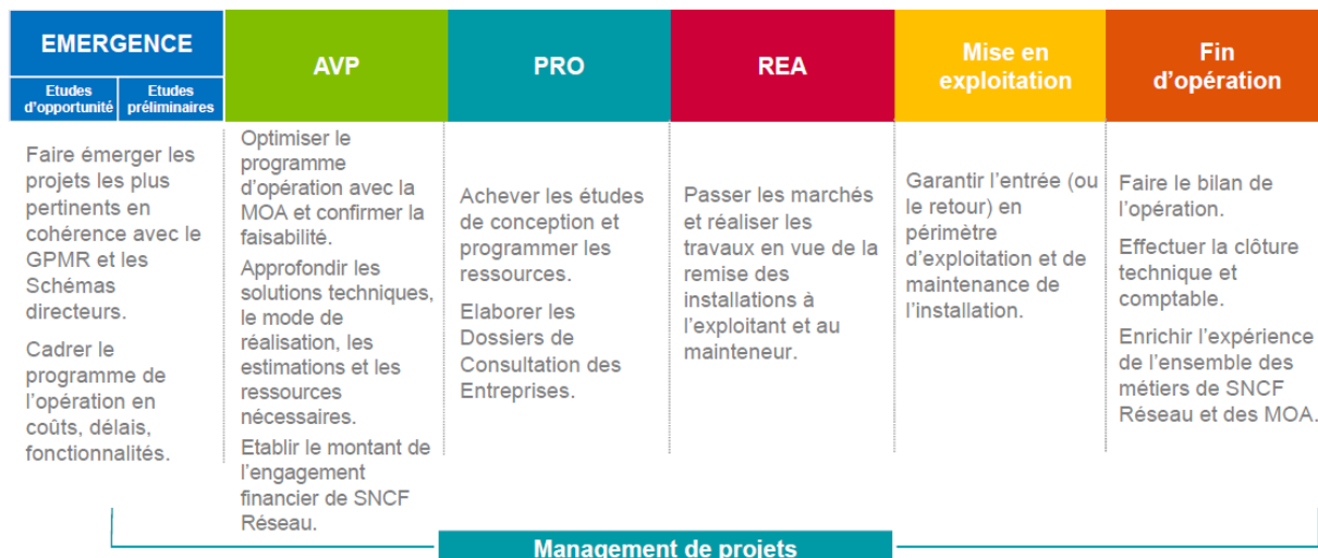
Figure 14. Les phases d'un projet ferroviaire (extrait du guide de management de projet interne)
