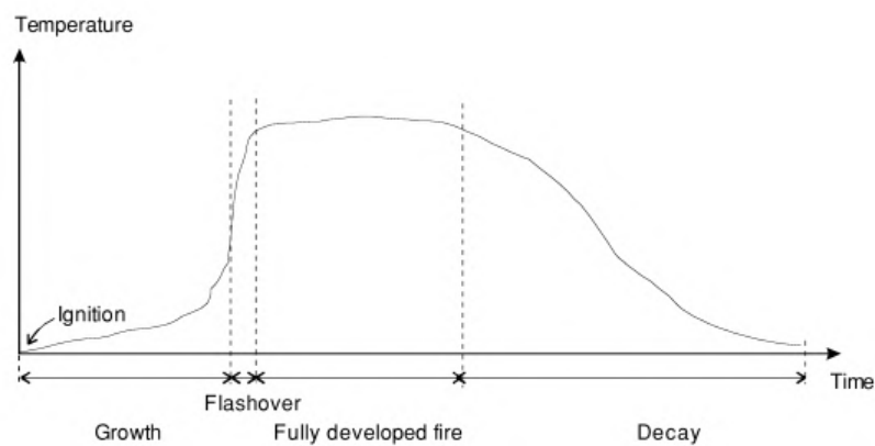
FIGURE 1.8 – Développement d'un incendie en milieu confiné (WALTON et al., 2016).
