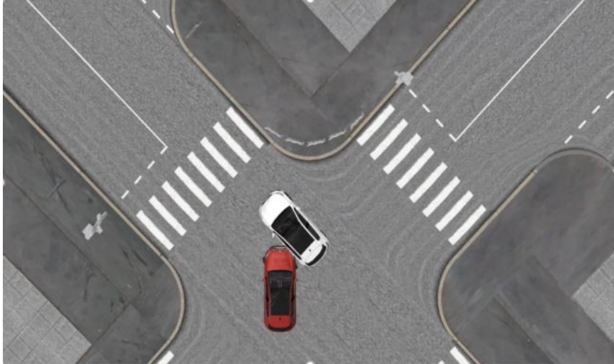
Figure 5.21 – Illustration de la collision lors du scénario de test sous SCANeR Studio : en absence de replanification, le conflit entre l'égo-véhicule (en rouge) et l'obstacle dynamique (en blanc) est inévitable
