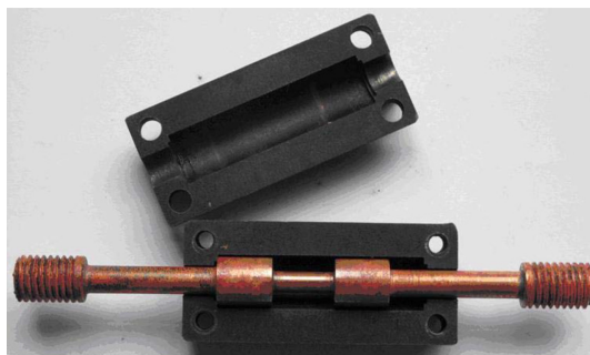
FIGURE I.31 – Illustration de la méthode d’essais interrompus aux barres d’Hopkinson par contrôle de l’élongation pour un matériau métallique proposée par Dongfang et al. (2010).
