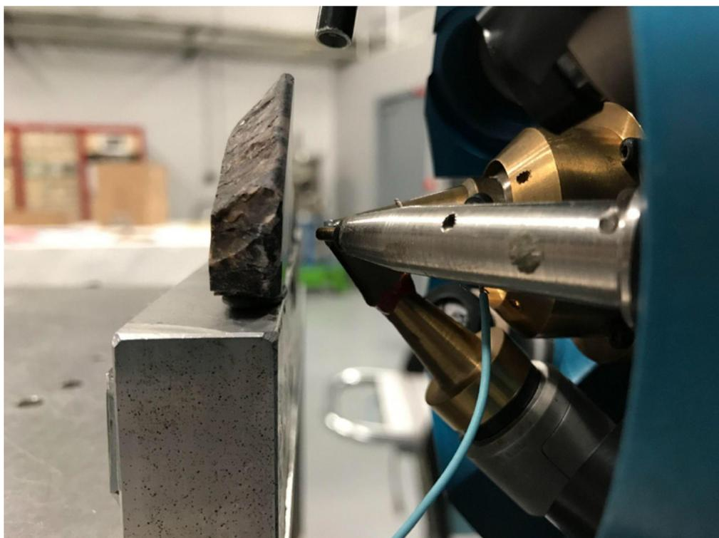
*Figure 030 : Extrémité du dispositif AGLAE lors de l'analyse d'une rhyolite géologique (Photo F.-X. Le Bourdonnec).*
