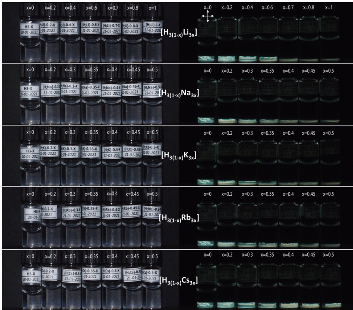
Figure 3-10 : Photographies de cinq séries d'échantillons contenus dans des piluliers observés en lumière naturelle (à gauche) et entre des polariseurs croisés (à droite). La fraction massique de nanofeuillets H_{3(1-x)}M_{3x}Sb_3P_2O_{14} est maintenue constante (0,17 wt%) pour toutes les séries. x augmente de gauche à droite comme décrit précédemment conduisant à une phase trouble où la biréfringence commence à disparaître entre polariseurs croisés (flèches croisées).
