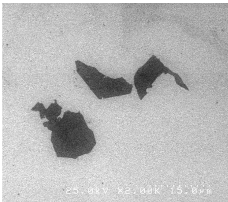
Figure 3-1 : Cliché MEB des nanofeuillets présents dans une suspension colloïdale de H_3Sb_3P_2O_{14} .
