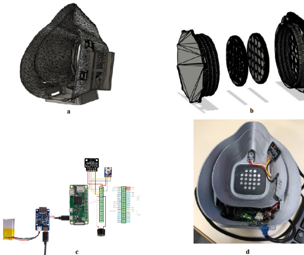
FIGURE A.6 – a : modélisation du masque ; b : mécanisme du respirateur ; c : schéma électrique de l'ensemble du masque ; d : masque avec l'électronique montée à l'intérieur
