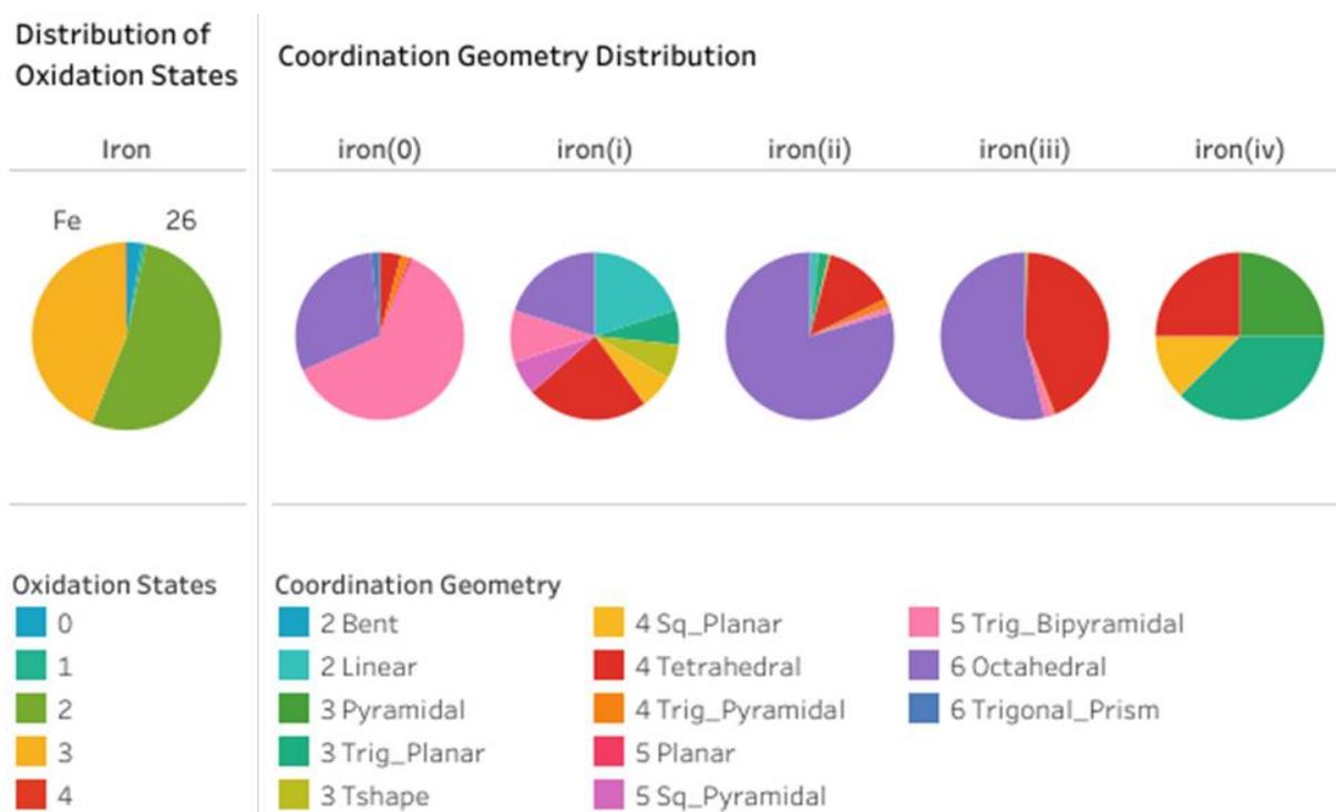
Figure 4 : Distribution des états d'oxydation et des géométries adoptées pour le fer selon la table de Stanley-Gray et al.<sup>16</sup>
