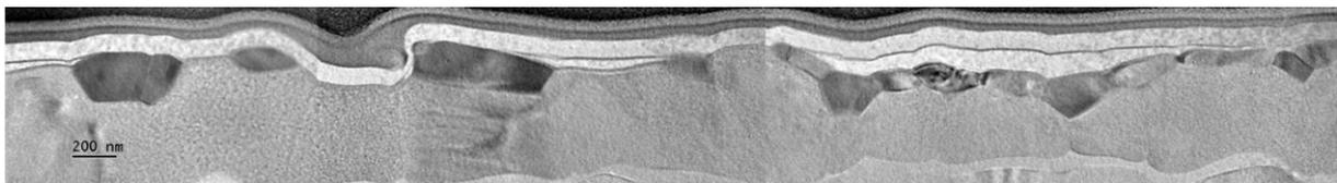
Figure 44 : Apparence du film mince après un recuit à 1100°C. Substrat de silicium en bas de l'image et platine en haut
