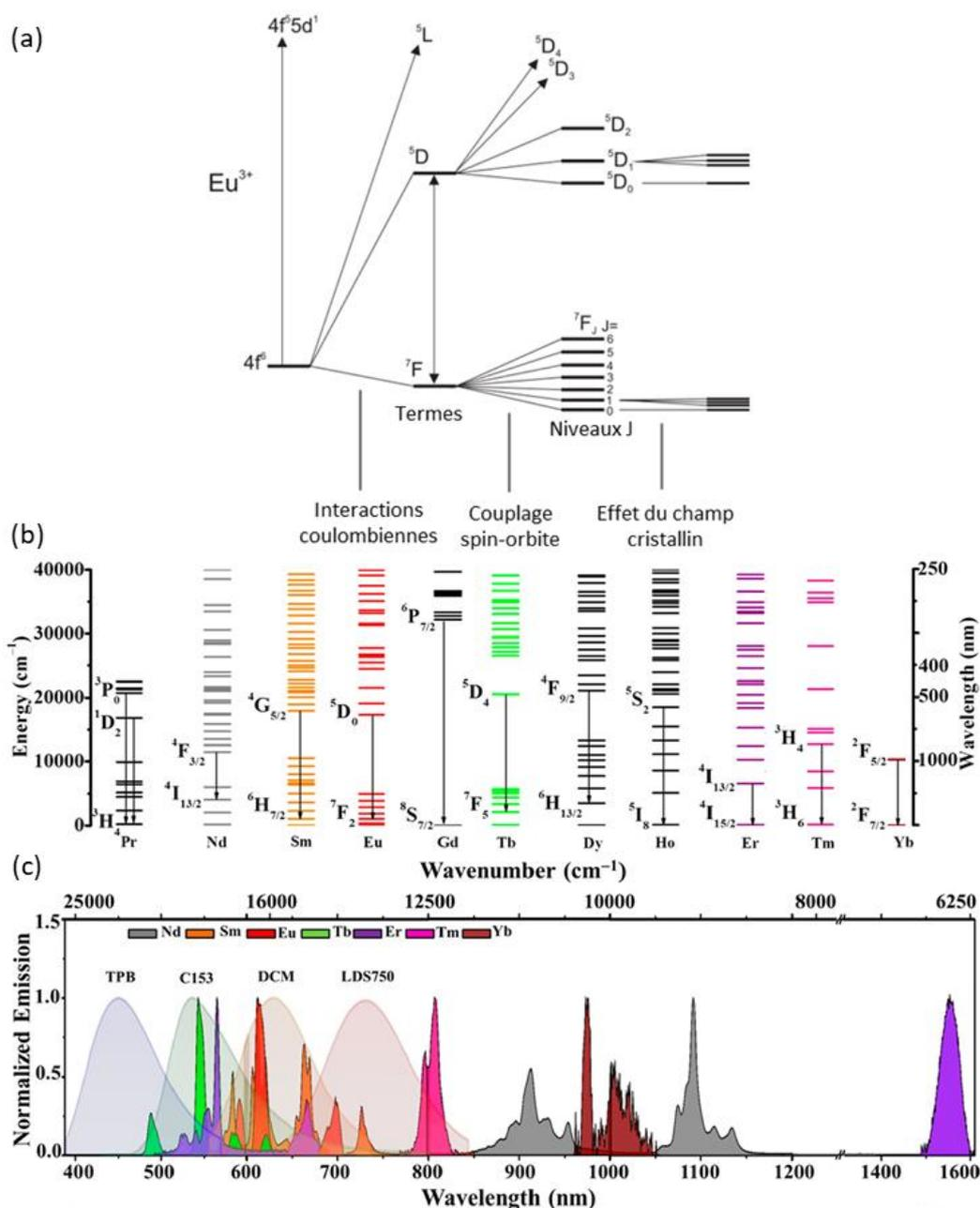
Figure 6 : (a) Diagramme d’énergie de l’euprécium III avec représentation des différents splittings de son orbitale  $4f$  (adapté de Werts et al.<sup>30</sup>) (b) et (c) Diagrammes d’énergie et spectres d’émission des ions lanthanides III (adaptés de Debnath et al.<sup>31</sup>)
