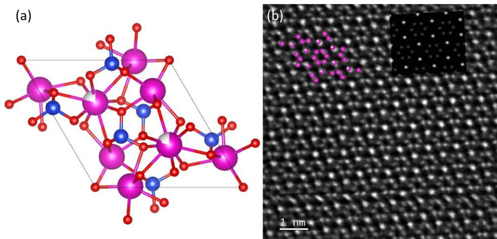
Figure 46 : (a) Modèle structural déduit des données de PEDT (b) Image STEM-HAADF de l'orientation [001] avec la projection structurale et la simulation correspondantes
