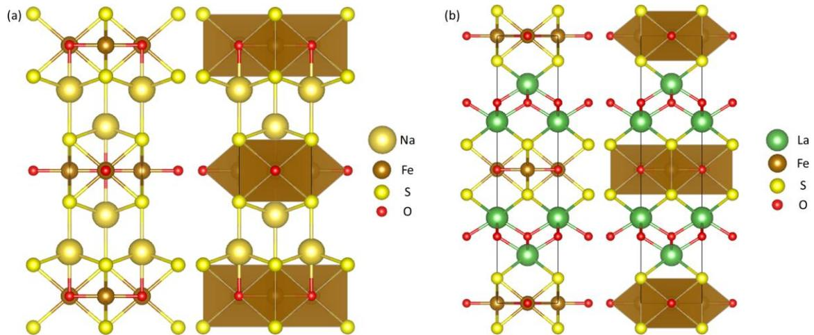
Figure 15 : (a) Modèle structural du composé  $\text{Na}_2\text{Fe}_2\text{OS}_2$ <sup>74</sup> (b)  $\text{La}_2\text{O}_2\text{Fe}_2\text{OS}_2$ <sup>75</sup>
