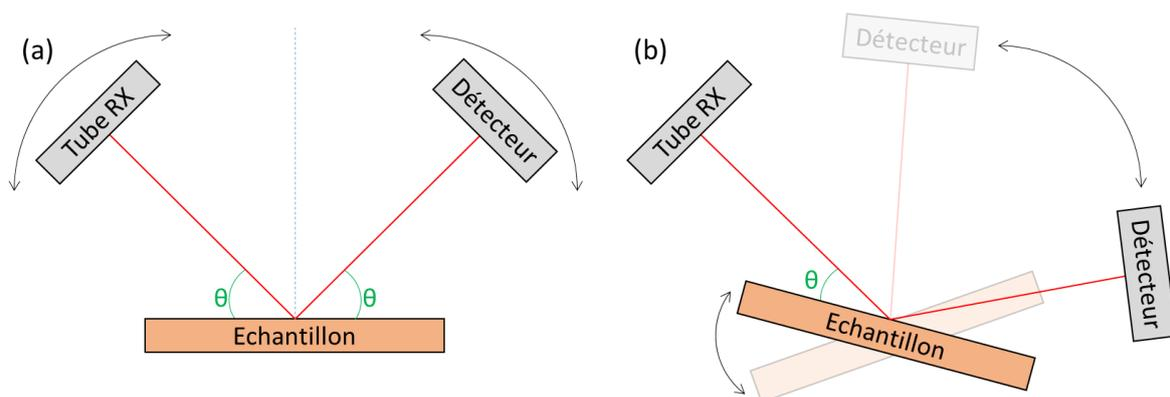
Figure 32 : (a) Montage Thêta-Thêta (b) Montage Thêta-2Thêta
