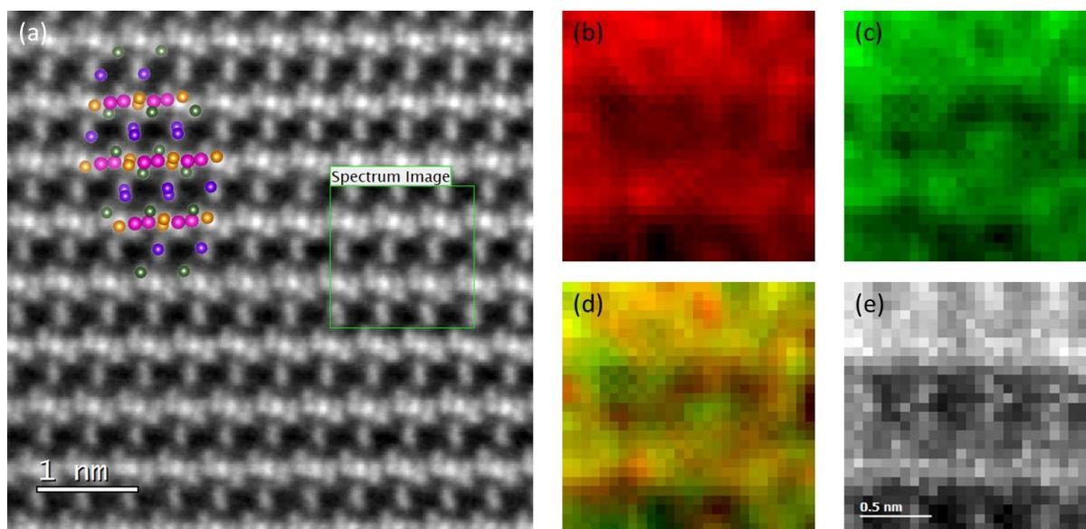
Figure 61 : (a) Image STEM-HAADF selon l'axe de zone  $[-111]$  (b-c) Cartographie STEM-EELS de l'Eu et du Tb respectivement (d) Superposition des cartographies des lanthanides (e) Image STEM-HAADF de la zone réellement sondée
