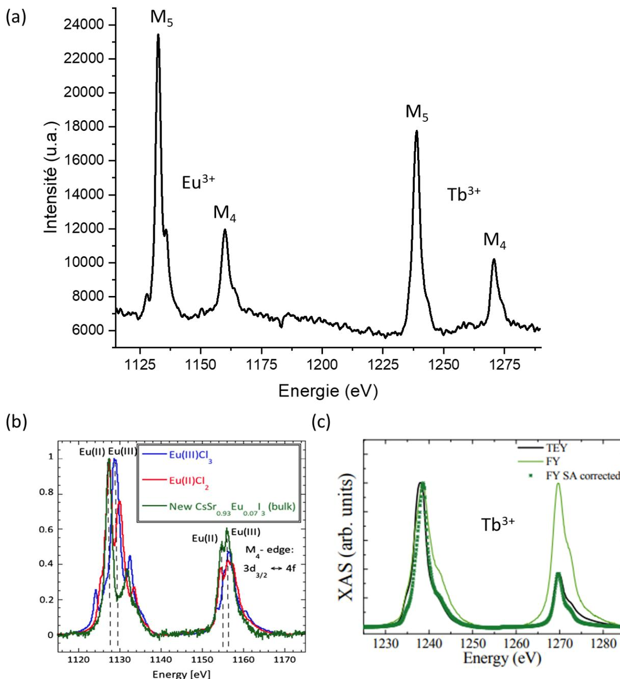
Figure 54 : (a) Spectre EELS expérimental acquis avec une dispersion de 0,1eV/canal (b) Signature en XAS de l'Europium sous différents degrés d'oxydation obtenue par Zhuravleva et al.<sup>85</sup> (c) Signature en XAS du Terbium  $3+$  dans  $\text{TbMnO}_3$  obtenue par Cuartero et al.<sup>86</sup>
