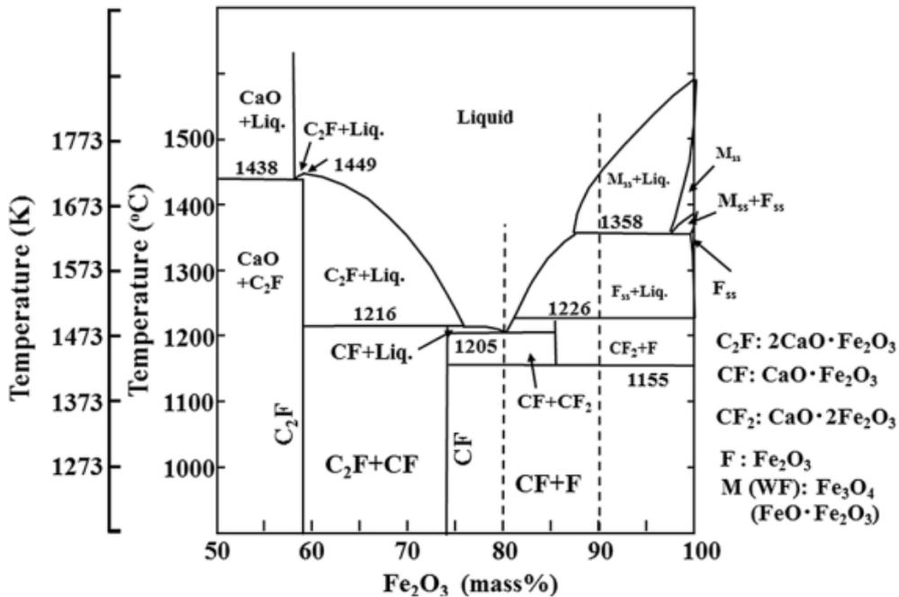
Figure 12 : Diagramme de phases obtenu dans le système Ca-Fe-O<sup>66</sup>
