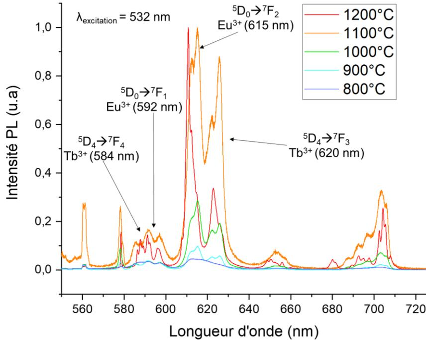
Figure 48 : Mesures des propriétés de photoluminescence des films de ZnO codopé avec Eu et Tb recuits à différentes températures
