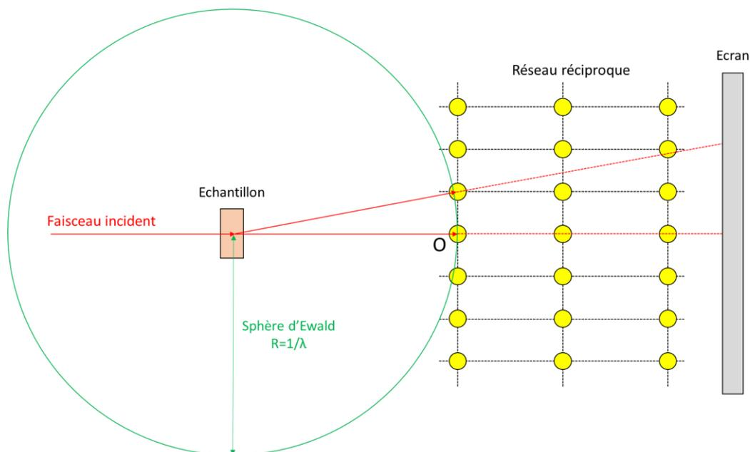
Figure 24 : Schéma représentant le principe de la diffraction
