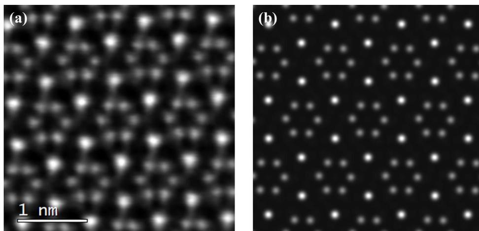
Figure 29 : (a) Image HAADF expérimentale (b) Simulation correspondante réalisée avec JEMS
