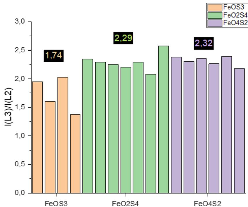
Figure 76 : Graphique représentant le rapport d'intensité  $I(\text{L3})/I(\text{L2})$  dans le cas de l'oxysulfure  $\text{CaFeOS}$  ( $\text{FeOS}_3$ ) et de l'oxysulfure  $\text{Ca}_4\text{Fe}_{6-x}\text{S}_4\text{O}_6$  ( $\text{FeO}_4\text{S}_2 / \text{FeO}_2\text{S}_4$ )
