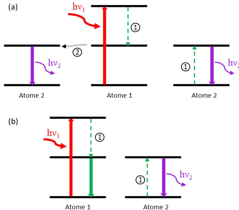
Figure 8 : (a) Schéma d’un mécanisme de quantum cutting avec intervention d’un transfert d’énergie et d’une relaxation croisée (b) un autre exemple de mécanisme de quantum cutting possible
