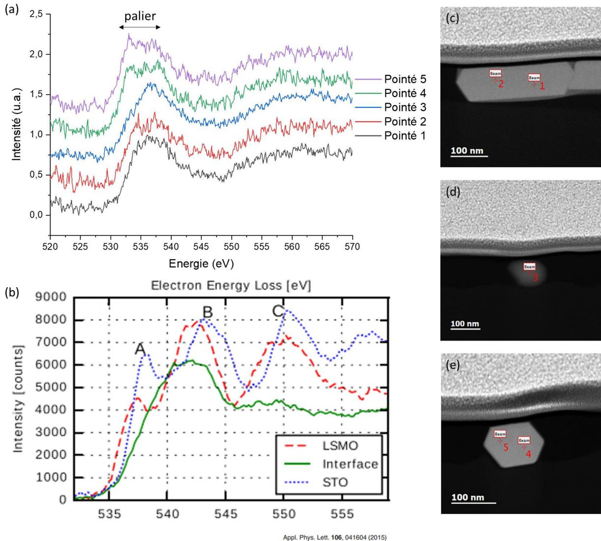
Figure 55 : (a) Analyses EELS du seuil d'oxygène acquises avec une dispersion de 0,1 eV/ch sur différentes inclusions (b) Seuils de l'oxygène obtenus par Nord et al.<sup>87</sup> dans le cas du film de LSMO déposé sur STO (c-e) Images HAADF avec l'emplacement des pointés d'analyse
