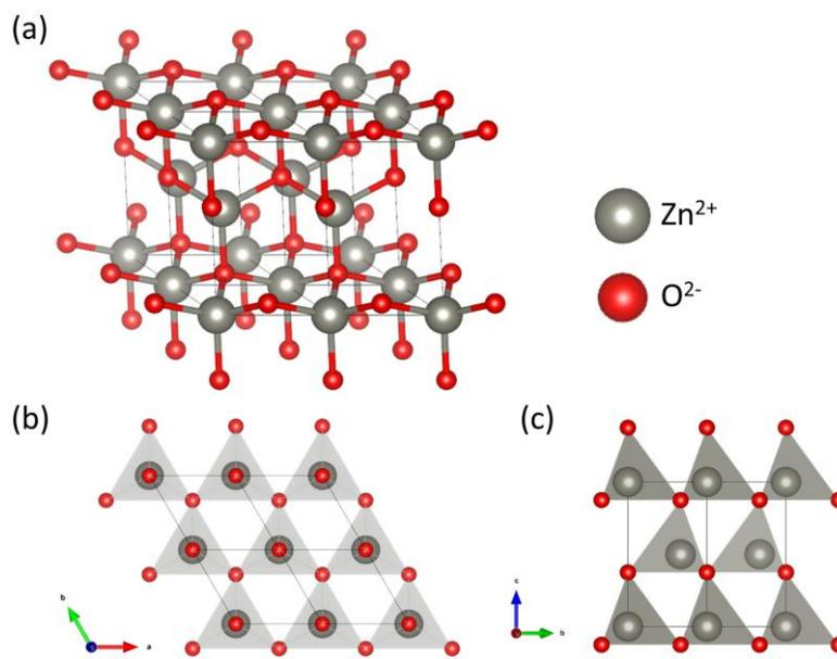
Figure 10 : Structure du ZnO type Wurtzite
