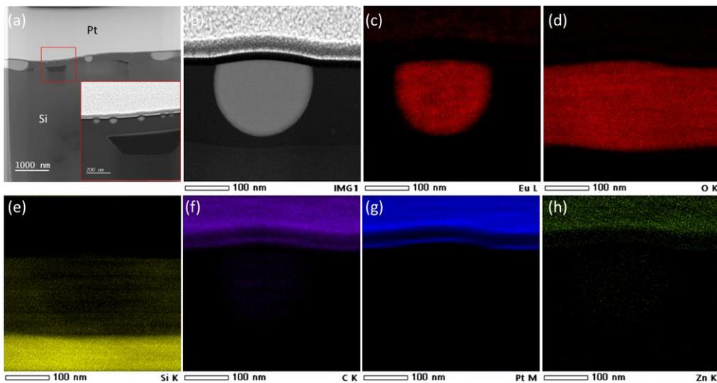
Figure 47 : (a) Image STEM-HAADF à faible grossissement d'une lame mince d'un autre film de ZnO dopé europium recuit à 1200°C (b) Image STEM-HAADF de la zone sondée en STEM-EDS (c-h) Cartographies chimiques des différents éléments
