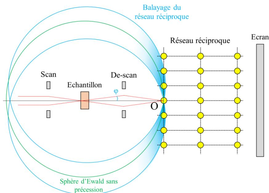
Figure 25 : Schéma illustrant le phénomène de précession dans un MET
