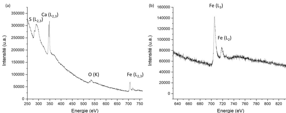
Figure 75 : Spectres EELS acquis avec une dispersion de (a) 0,25 et (b) 0,1 eV/canal respectivement
