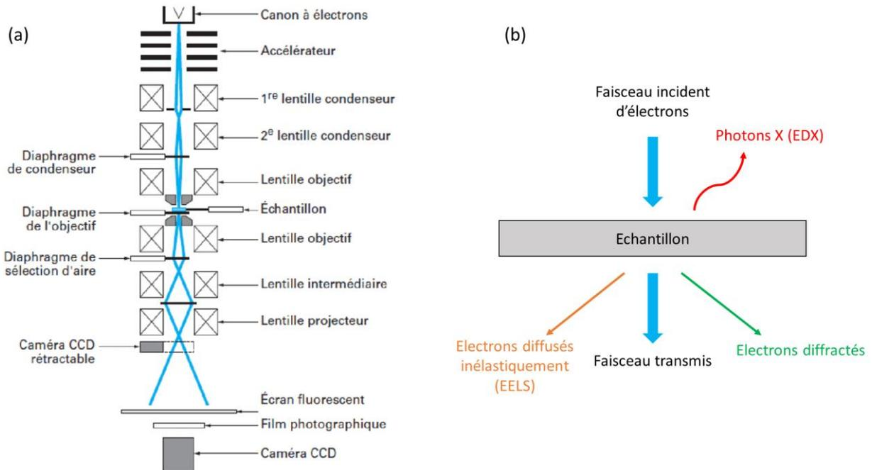
Figure 23 : (a) Coupe schématique d'un MET<sup>76</sup> (b) Les principales interactions électrons/matière exploitées en MET
