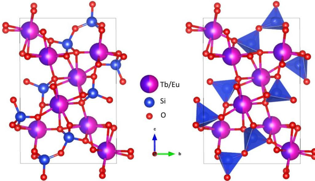
Figure 57 : Modèle structural déterminé et affiné du disilicate de terbium et d'euprimum  $(Eu,Tb)_2Si_2O_7$
