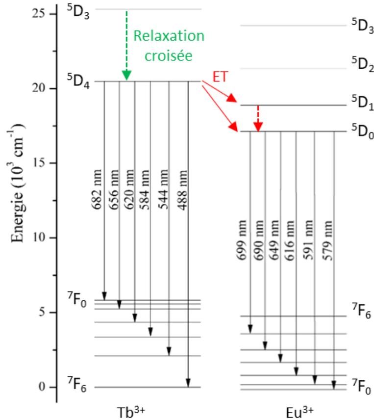
Figure 9 : Digramme d'énergie du  $Tb^{3+}$  et de l' $Eu^{3+}$  avec la relaxation croisée Tb-Tb et le transfert d'énergie Tb-Eu (adaptée des travaux de Davesne<sup>6,7</sup>)
