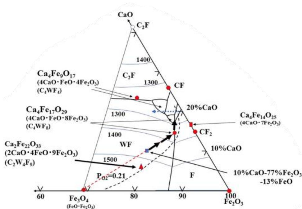
Figure 13 : Diagramme ternaire obtenu pour le système Fe<sub>3</sub>O<sub>4</sub> - Fe<sub>2</sub>O<sub>3</sub> - CaO<sup>67</sup>
