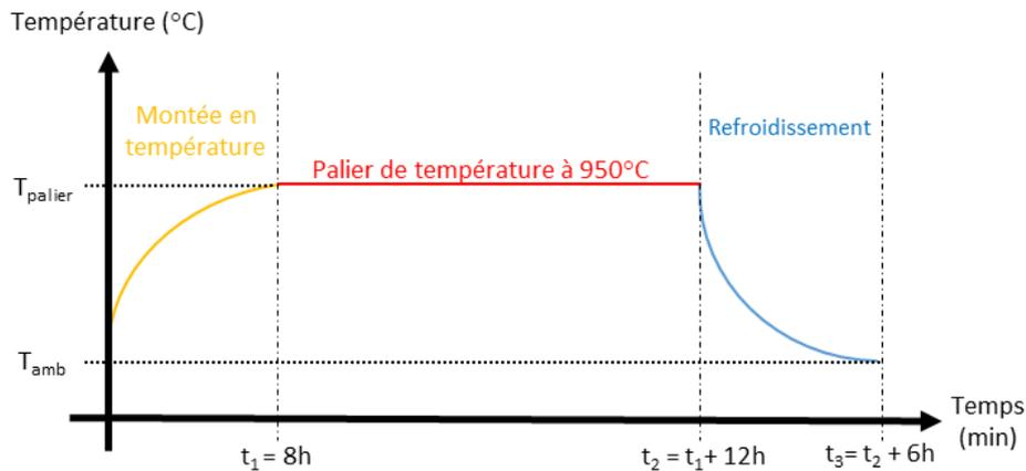
Figure 19 : Cycle thermique réalisé pour la synthèse des composés  $\text{CaOFeS}$  et  $\text{CaO}_x\text{Fe}_{1,25}\text{S}$
