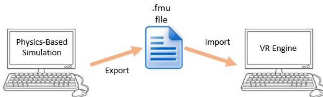
Figure 76 : Couplage d'une simulation avec un moteur de rendu grâce à des modèles standardisés
