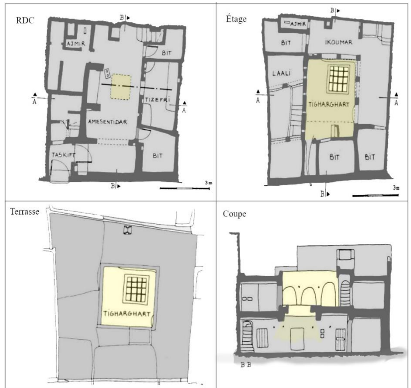
Figure 147 : Plans et coupe d'une maison du M'Zab (C. Bousquet, Annuaire de l'Afrique du Nord , 1986, Tome XXV, pp. 258-263, modifié par l'auteur)
