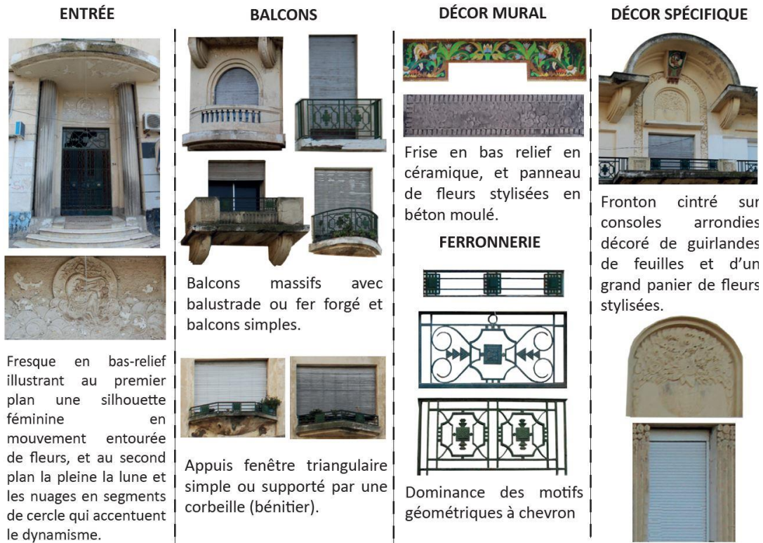
Figure 200 : Extrait de la grille de l'immeuble « Palais Beauséjour » IM_01, présentation des séquences de lecture (auteur, 2021)
