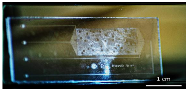
Figure 96 : Photographie du microréacteur en saphir de type poreux hétérogène utilisé pour les expériences d'invasion du CO 2 .
