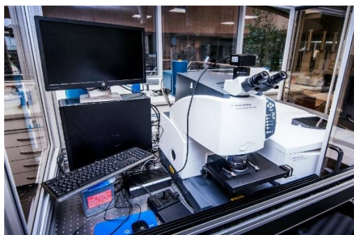
Figure 54 : Spectromètre infrarouge Cary 600 Series couplé à un microscope de la marque Agilent Technologies.
