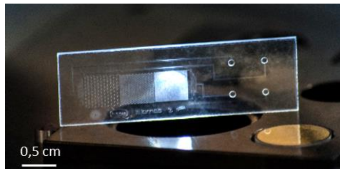
Figure 47 : Image d'un microréacteur transparent en saphir ayant un « design » de type milieu poreux.
