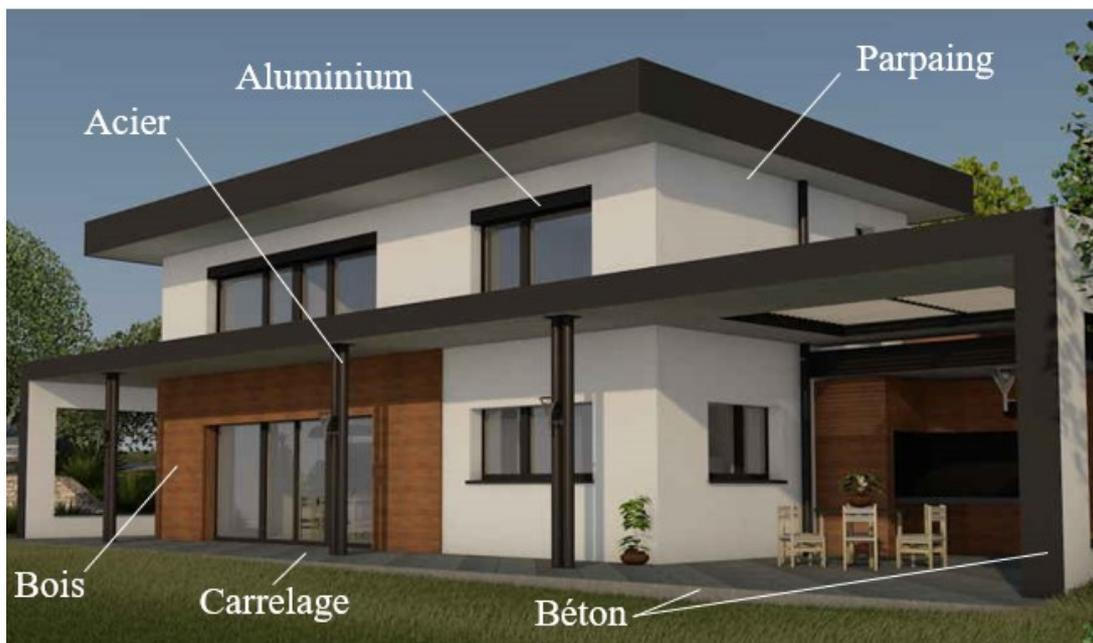
FIGURE 5.2 – Principaux matériaux de construction et produits utilisés
