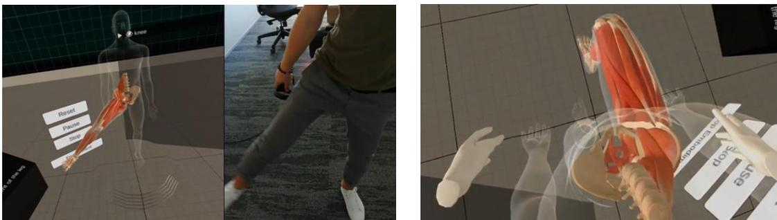
**Figure 52** : Exemple du logiciel avec casque de réalité virtuelle. Vision de l'utilisateur sur ses propres mouvements (via l'avatar numérique) avec le casque Oculus.
