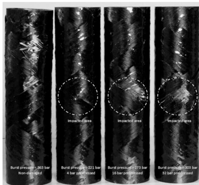
Figure 1-8: Rupture par éclatement des pipes hybrides précontraintes avec impact au niveau d'énergie de 20 J. [26].
