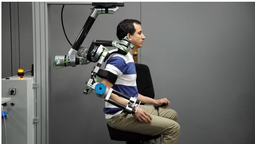
Figure 1.4 – Exosquelette de membre supérieur à 7 degrés de libertés actifs ANYExo (source : ETH Zürich research collection).
