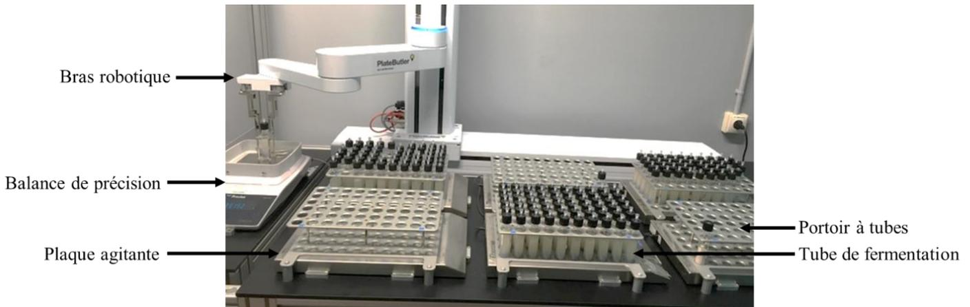
**Figure 23** : Photo du robot PhenOFerm en configuration « tubes »
