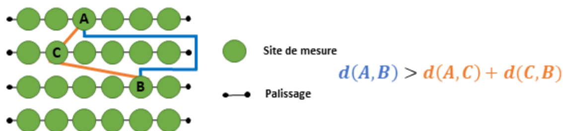
Figure 1.7 : La longueur des chemins séparant deux sites de mesure ne respecte pas l'inégalité triangulaire. Sans assigner un site de mesure à un inter-rang d'accès, la définition de distance ne s'applique pas.
