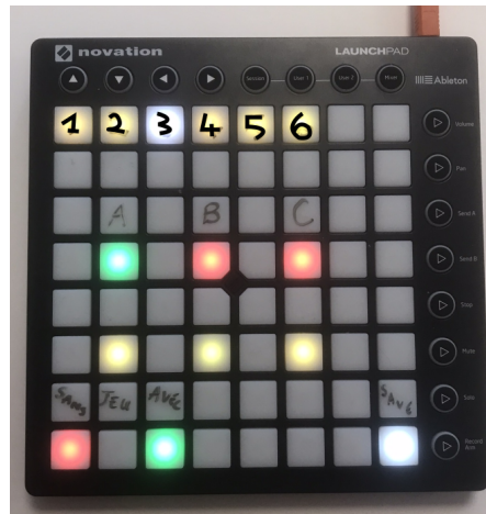
FIGURE 6.4 – Interface MIDI Novation Launchpad MIDI avec laquelle les guitaristes interagissent. En haut, le numéro de la note à jouer est indiqué (de 1 à 6), les boutons au milieu en rouge ou en vert permettent de choisir le signal généré (A, B ou C) et les boutons en jaune en dessous permettent aux guitaristes de répondre en déterminant le signal qu'ils pensent être différent des autres. Les boutons en bas à gauche indiquent le mode de déclenchement des signaux (voir l'explication de la Phase dans cette section), et le bouton en bas à droite permet d'enregistrer la réponse pour passer aux signaux suivants.
