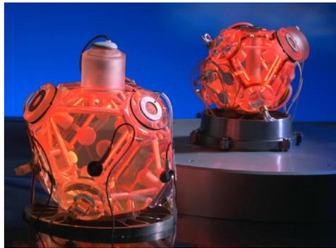
Figure 2 – Photographie de gyrolasers fabriqués par Thales, issue d'un document Thales Group.
