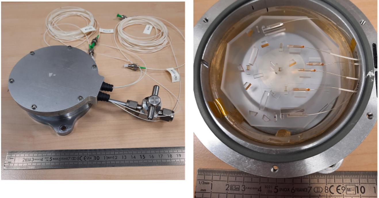
Figure 4.6 – Photographies des parties extérieure et intérieure du boîtier de la cavité en fibre à cœur creux PBG.
