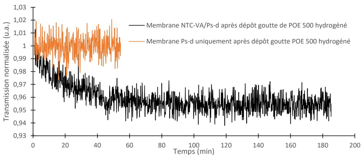
Figure 52 : Courbes représentant l'évolution de l'intensité intégrée de la membrane NTC/PS-d (en noir) et de la membrane en PS-d uniquement (en orange) après dépôt d'une goutte de POE  $500 \text{ g}\cdot\text{mol}^{-1}$  hydrogéné.
