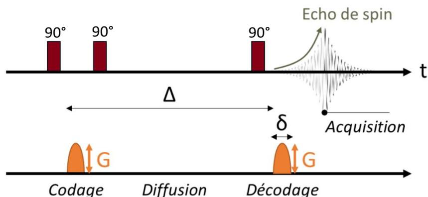
Figure 74 : Schéma d'un écho de spin stimulé. (d'après la thèse de G. PIANA)<sup>150</sup>
