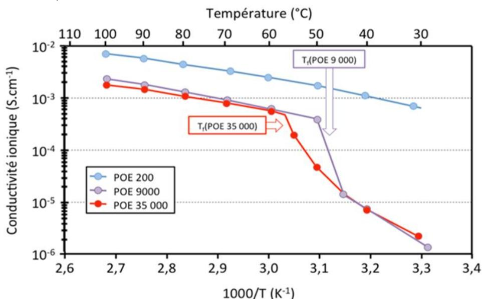
Figure 8 : Conductivité ionique en fonction de la température pour des complexes POE/LiTFSI ([OE]:[Li]=25) pour différentes masses molaires de 200, 9000 et 35 000 g.mol<sup>-1</sup>. (d'après la thèse de Adèle FERRAND)<sup>86</sup>
