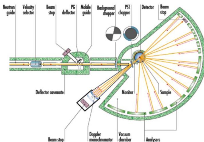
Figure 65 : Schéma détaillé du spectromètre à géométrie inversée IN16B<sup>8</sup>.
