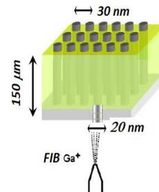
Figure 97 : Membrane NTC pore unique produite par FIB.
