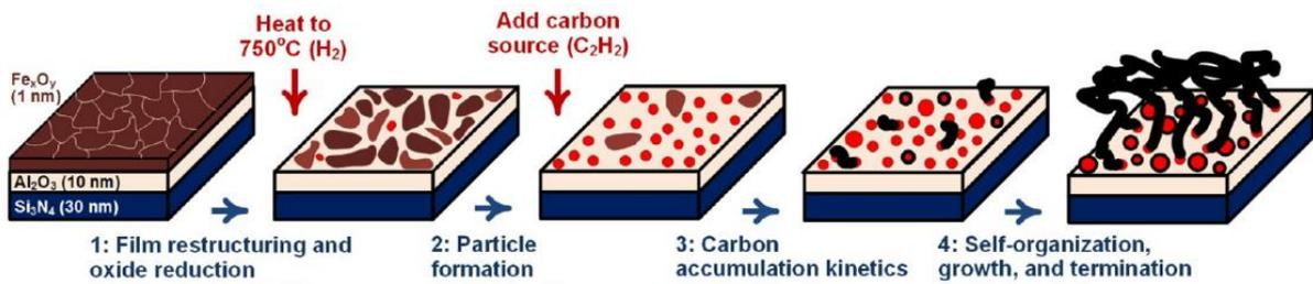
Figure 14 : Schémas décrivant les différentes étapes successives de la nucléation et la croissance de nanotubes de carbone verticalement alignés, par Bedewi et al. en 2016<sup>109</sup>.
