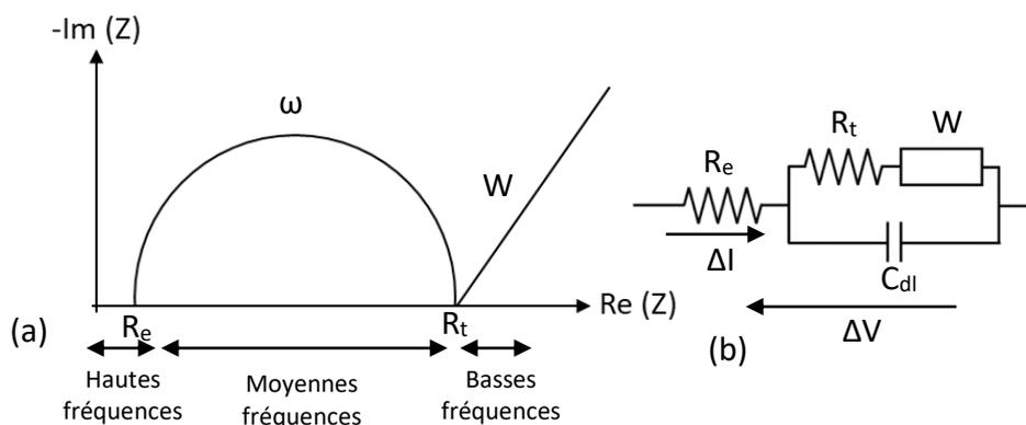
Figure 80 : (a) Représentation d'un diagramme de Nyquist d'une cellule électrochimique avec électrode actives, (b) Représentation de son circuit équivalent.
