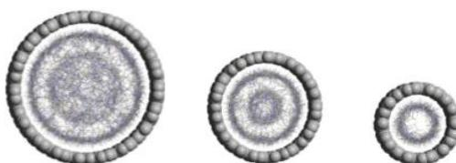
Figure 11 : Profil de densité numérique d'atomes au sein de tube de (a) 20 nm ; (b) 15 nm et (c) 10 nm de diamètre. Le liquide ionique utilisé est l'ethylmethylimidazolium thiocyanate [EMIm][SCN]<sup>-101</sup>.
