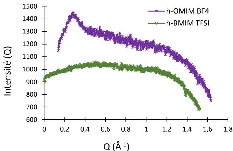
Figure 118 : Spectre représentant l'intensité en fonction de Q pour OMIM BF<sub>4</sub> (en violet) et BMIM TFSI (en vert).
