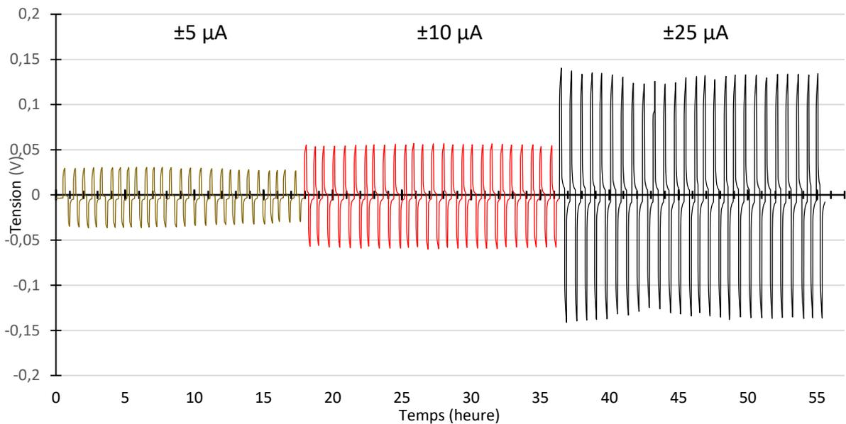
Figure 94 : Courbe de cyclage galvanostatique obtenue pour une cellule  $\text{Li}|\text{DW-DW}|\text{Li}$  imbibée par  $\text{POE } 500 \text{ g.mol}^{-1}$   $\text{LiTFSI}$   $[\text{OE}]:[\text{Li}]=25$  pour différents courants  $\pm 5 \mu\text{A}$ ,  $\pm 10 \mu\text{A}$  et  $\pm 25 \mu\text{A}$  appliqués 8 minutes.
