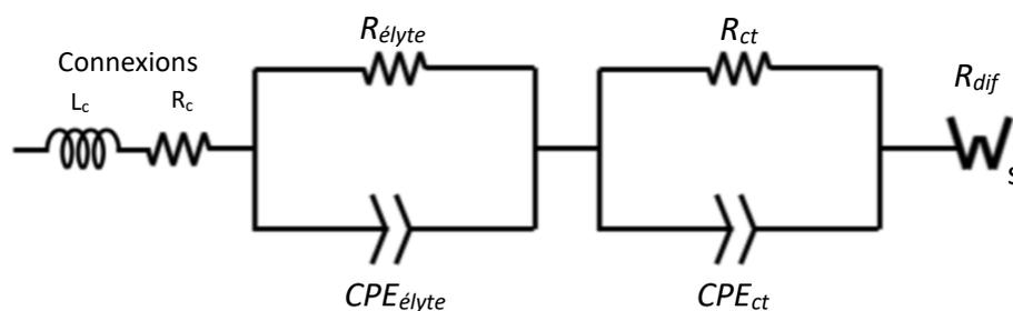
Figure 93 : Schéma du circuit équivalent de la représentation de Nyquist pour l'impédance mesurée de l'échantillon n°6.
