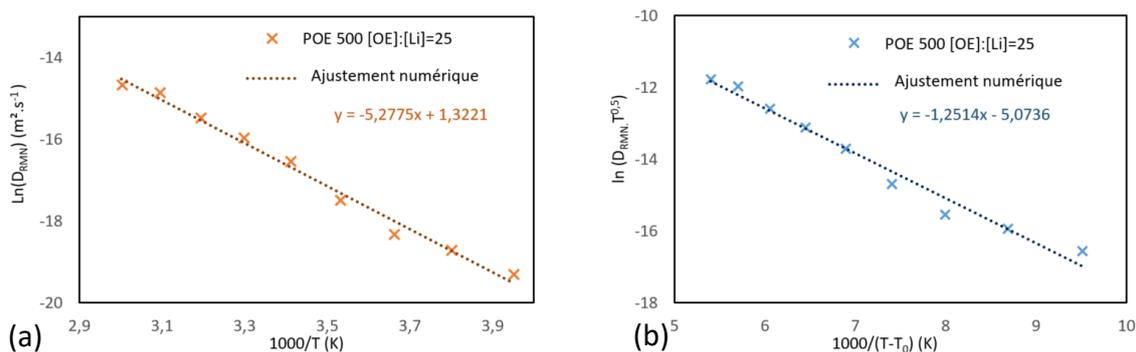
Figure 76 : Evolution du  $D_{RMN}$  en fonction de la température pour POE 500 g.mol<sup>-1</sup> [OE]:[Li]=25 (a) avec l'ajustement VTF et (b) avec l'ajustement Arrhenius.
