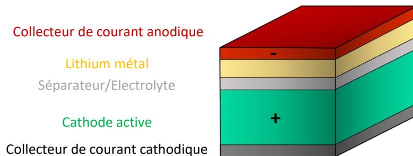
Figure 5 : Schéma d'une batterie lithium tout-solide.
