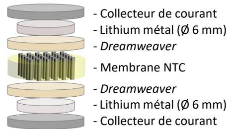
Figure 95 : Schéma du système en cyclage.
