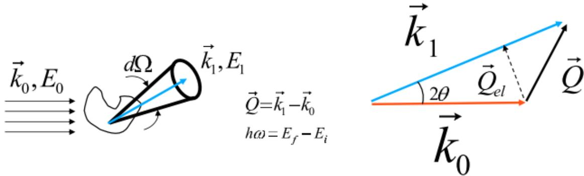
Figure 63 : Schéma du principe d'une expérience de diffusion de neutrons. (d'après l'HDR de J-M. ZANOTTI)<sup>146</sup>
