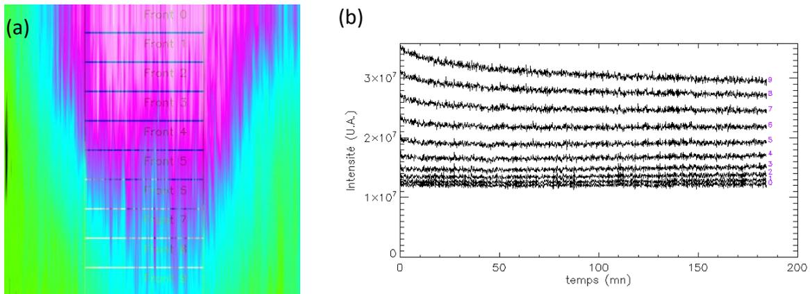
Figure 51 : (a) Agrandissement de la zone d'intérêt de la membrane (épaisseur  $100 \mu\text{m}$ ) à la fin du processus. L'électrolyte apparaît en violet. L'image est segmentée en 10 fronts, d'épaisseurs égales et notés de 0 (haut de la membrane) à 9 (bas) (b) Courbe de transmission des neutrons pour les différents fronts en fonction du temps (indiqués à la droite de chaque courbe).
