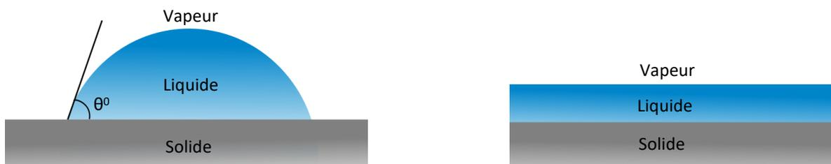
Figure 29 : Les deux états de mouillage : mouillage partiel / mouillage complet. (d'après la thèse de Safi Melki)<sup>130</sup>
