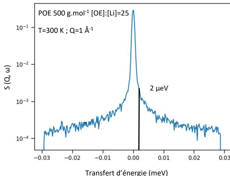
Figure 69 : Exemple de spectre QENS mesuré sur IN16B. Lors d'un IFWS le transfert d'énergie est fixé à 2  $\mu\text{eV}$  pour suivre l'évolution de l'intensité du signal en fonction de la température (pour chaque valeur de  $Q$ ).
