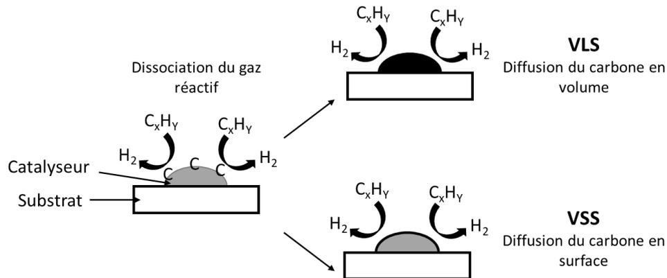
Figure 12 : Schéma des mécanismes VLS et VSS. (inspiré de la publication de Tessonier et al.)<sup>106</sup>
