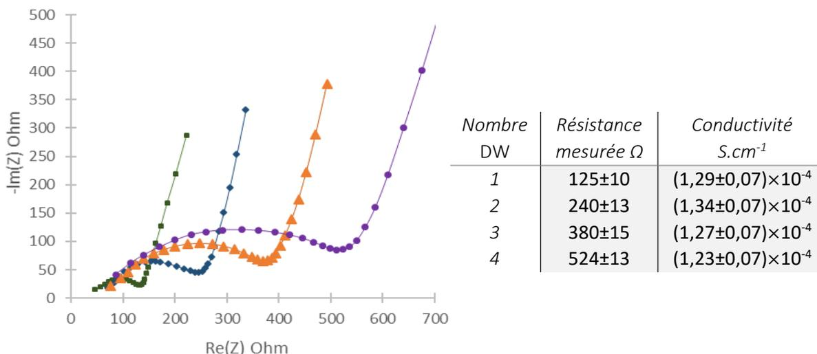
Figure 83 : Diagrammes de Nyquist obtenus pour différents nombres de DW 25°C imbibé d'une solution de POE 500  $g.mol^{-1}$  LiTFSI [EO]:[Li]=25 et tableau récapitulatif des résistances et conductivités correspondantes.
