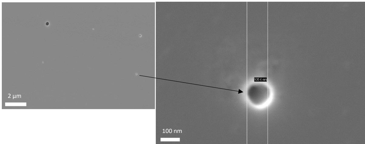
Figure 102 Photographie MEB du côté débouchant du trou obtenu avec les paramètres précédemment cités.
