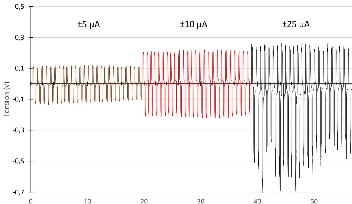
Figure 96 : Courbe de cyclage galvanostatique obtenue pour une cellule Li-DW|NTC|DW-Li imbibée par POE  $500 \text{ g.mol}^{-1}$  et 1M de LiTFSI, pour différents courants  $\pm 5 \mu\text{A}$ ,  $\pm 10 \mu\text{A}$  et  $\pm 25 \mu\text{A}$  appliqués 8 minutes.
