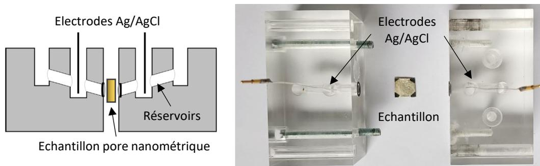
Figure 115 : Schéma et image représentant la cellule électrochimique utilisée.
