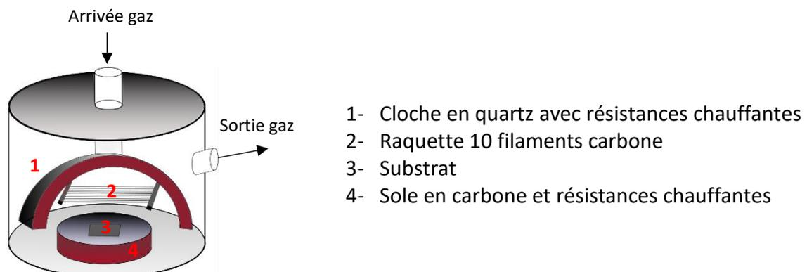
Figure 16 : Schéma du réacteur CVD Plassys assisté par filaments chauds. (inspiré de la thèse de Lorie DAVID)<sup>122</sup>
