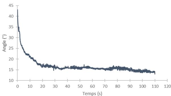
Figure 38 : Evolution de l'angle d'une goutte de POE (500 g.mol<sup>-1</sup>) sur une surface en Polystyrène uniquement.
