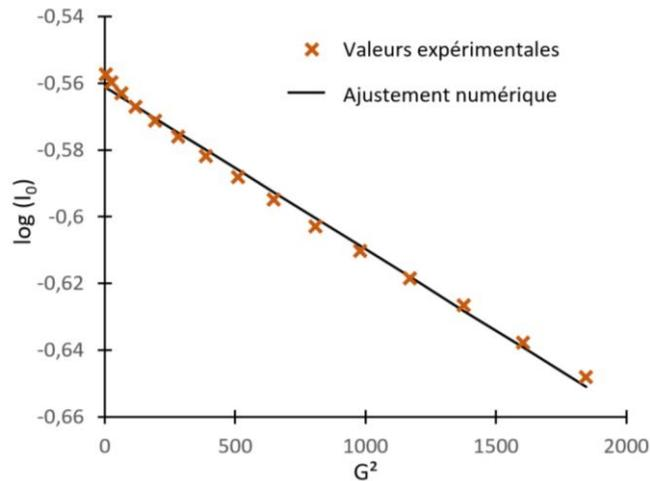
Figure 75 : Evolution de l'intensité en fonction de la valeur de l'impulsion  $G$  appliquée pour le noyau d'hydrogène. La courbe d'ajustement en noire est obtenue à partir de l'équation de Stejskal et Tanner<sup>151</sup>.
