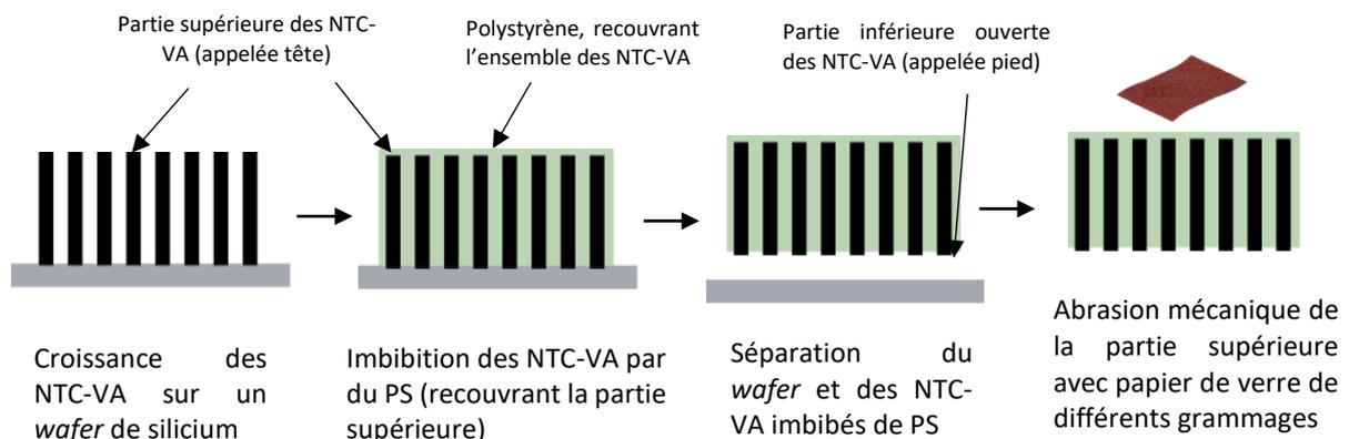
Figure 25 : Schéma illustrant la préparation d'une membrane.
