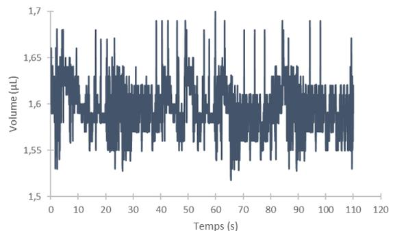
Figure 39 : Evolution du volume d'une goutte de POE (500 g.mol<sup>-1</sup>) sur une surface en Polystyrène uniquement.
