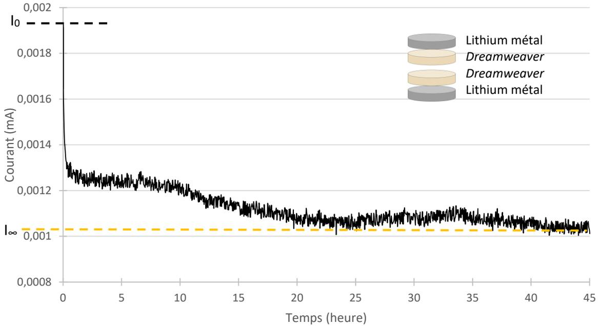
Figure 90 : Chrono-ampérométrie pour 2 DW POE 500 g.mol<sup>-1</sup> LiTFSI [OE]:[Li]=25 - potentiel appliqué + 10 mV (Ech.1).
