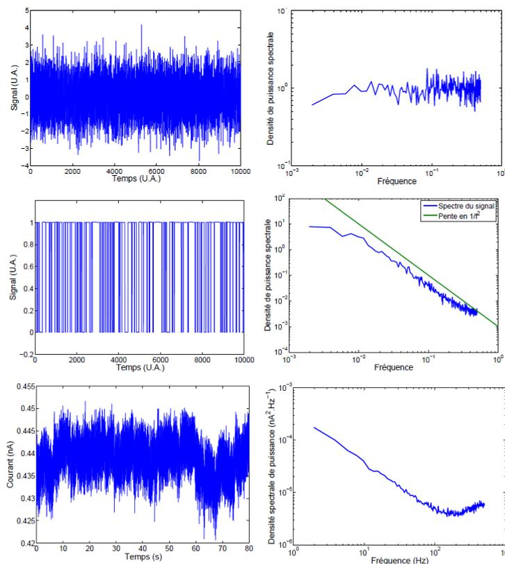
Signal d'un bruit blanc gaussien, le spectre de densité de puissance est indépendant de la fréquence. Pouvant illustrer un transport fluide sans fluctuations de densité ou de charge dans un nanopore.
