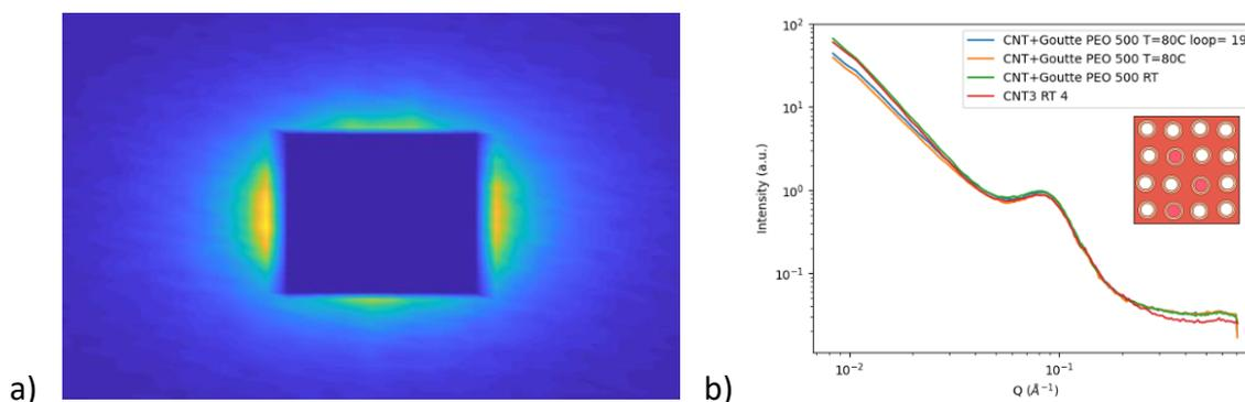
Figure 48 : a) Spectre brut 2D mesuré sur (D22, ILL). Le carré central correspond au beam-stop. b) Spectre de la membrane PS-d vide (orange) et chargée en POE-d 500 g.mol<sup>-1</sup> après regroupement isotrope et signal incohérent soustrait. L'insert en écho à la Figure 45 représente une cause possible de l'absence de matching : une fraction des pores n'est pas remplie.
