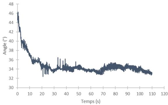
Figure 35 : Evolution de l'angle d'une goutte de POE (500 g.mol<sup>-1</sup>) sur une surface NTC-VA/Polystyrène.
