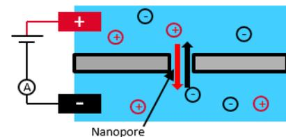
Figure 114 : Schéma d'un nanopore dans un bain électrolytique.
