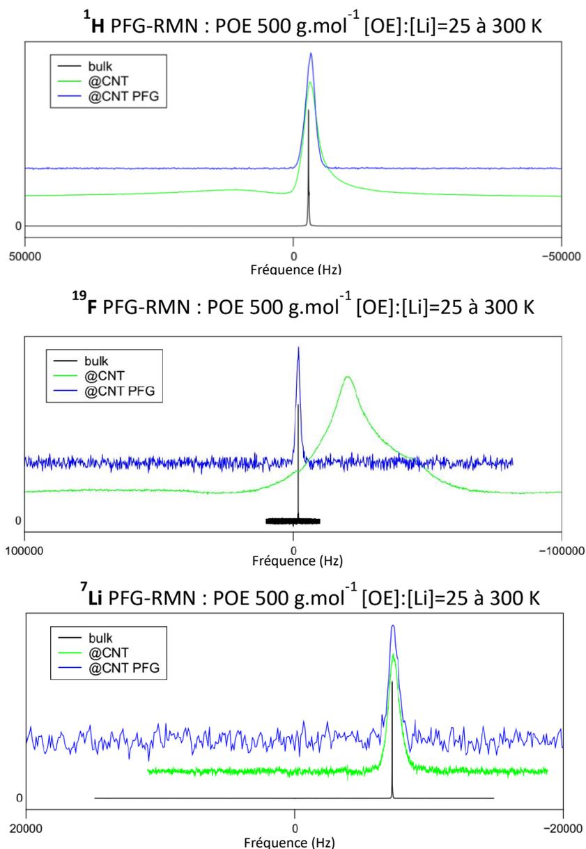
Figure 77 : Spectres RMN obtenus pour les noyaux <sup>1</sup>H, <sup>7</sup>Li, <sup>19</sup>F pour POE 500 g.mol<sup>-1</sup> LiTFSI [OE]:[Li]=25 à 300K. La courbe noire correspond au POE bulk, la courbe verte au signal confiné et la courbe bleue au signal confiné filtré par la mesure en gradient de champ.
