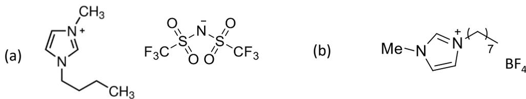
Figure 117 : Formules chimiques (a) BMIM TFSI (b) OMIM BF<sub>4</sub>.
