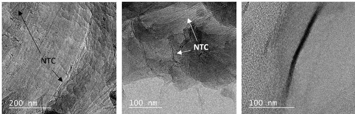
Figure 55 : Images MET obtenues pour une découpe de membrane perpendiculaire aux tubes
