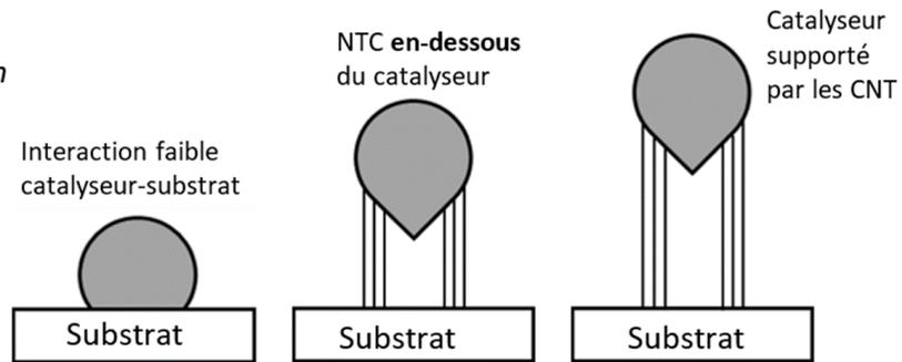
Figure 13 : Schéma des mécanismes de croissance *base-growth* et *tip-growth*. (inspiré de la thèse de Marie Fontana)<sup>108</sup>
