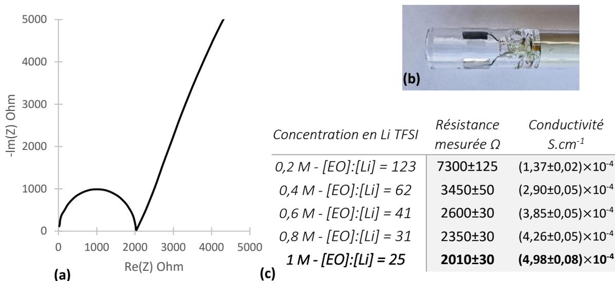
Figure 81 : (a) Représentation de Nyquist pour une solution de POE 500 g.mol<sup>-1</sup> LiTFSI [EO]:[Li] =25, (b) Electrode de mesure de bulk utilisée pour les mesures de résistances des différentes solutions (c) tableau récapitulatif des résistances et conductivités pour différentes concentration en LiTFSI obtenues à température ambiante.
