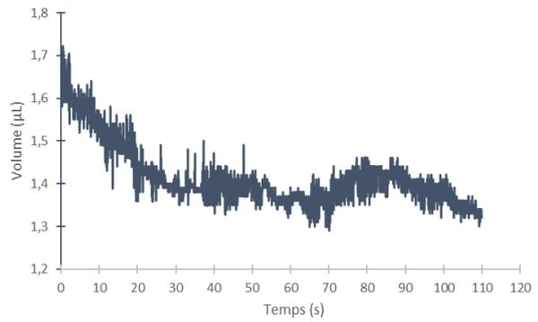
Figure 36 : Evolution du volume d'une goutte de POE (500 g.mol<sup>-1</sup>) sur une surface NTC-VA/Polystyrène.
