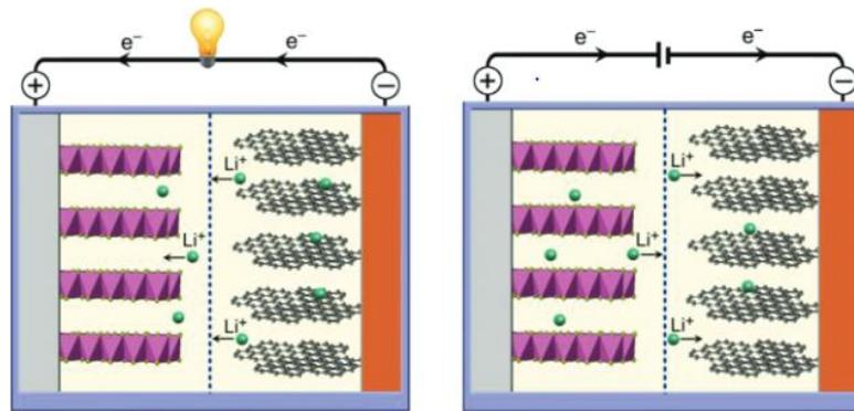
Figure 3 : Schéma représentant une batterie lithium, (a) Batterie en fonctionnement (décharge), (b) batterie en charge. (d'après Liang et al.)<sup>12</sup>
