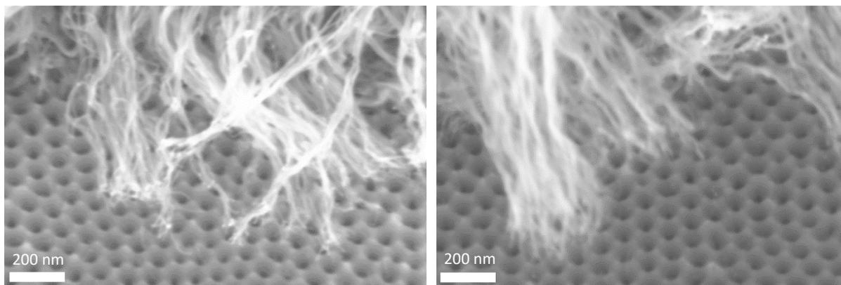
Figure 108 : Cliché MEB de NTC-VA sur AAO - 1 min de croissance, 40 nm de diamètre.
