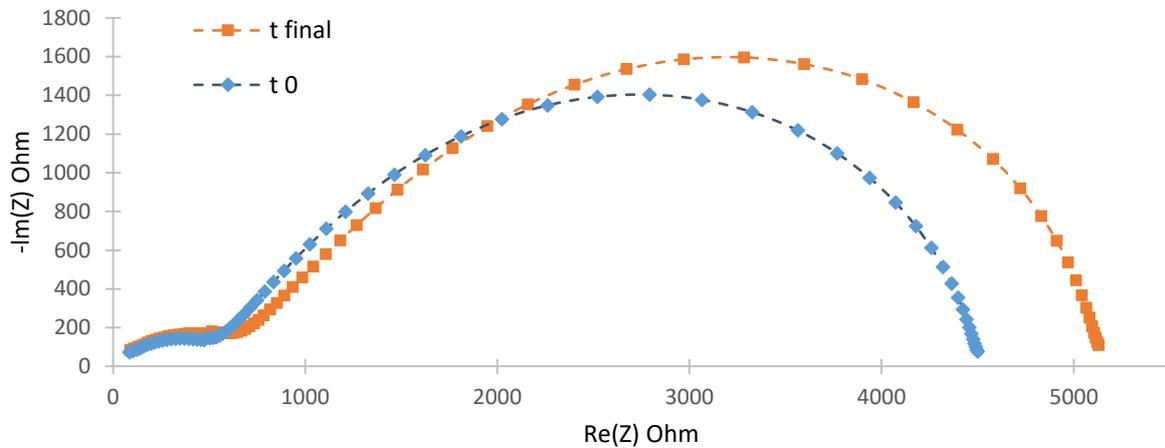
Figure 91 : Diagramme de Nyquist des impédances mesurées avant ( $t_0$ ) et après ( $t_{final}$ ) la polarisation, dans le système 2 POE 500 g.mol<sup>-1</sup> LiTFSI [OE]:[Li]=25 – Ech.1.
