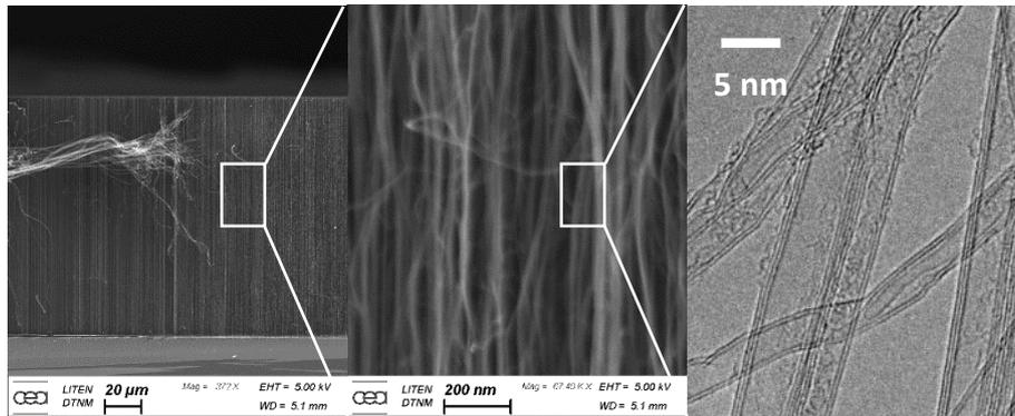
Figure 20 : Image MEB/TEM des NTC-VA à différentes échelles.
