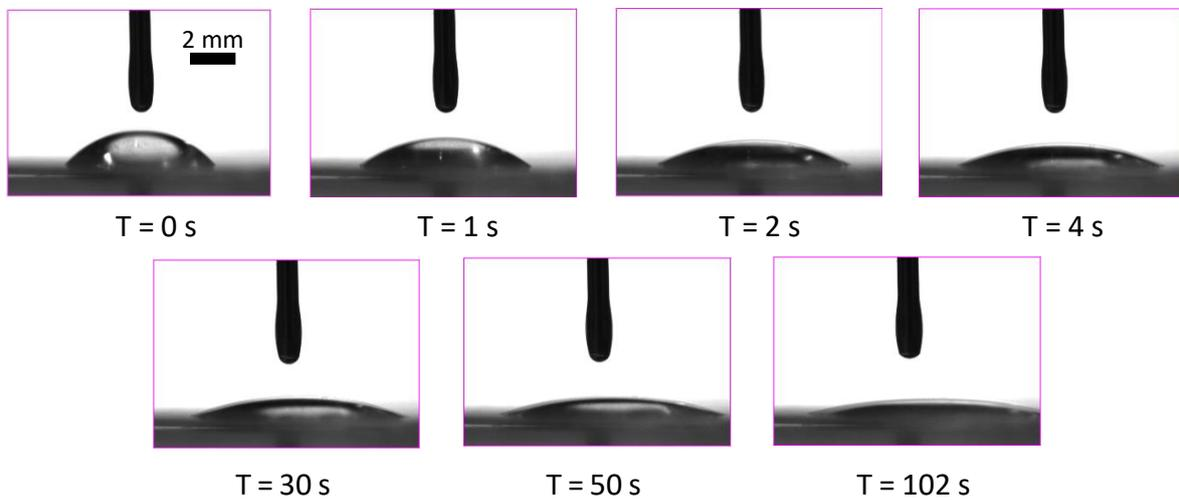
Figure 37 : Images de la goutte de POE (500 g.mol<sup>-1</sup>) obtenue sur un morceau de polystyrène. Le temps écoulé depuis le dépôt est indiqué sous chaque cliché.
