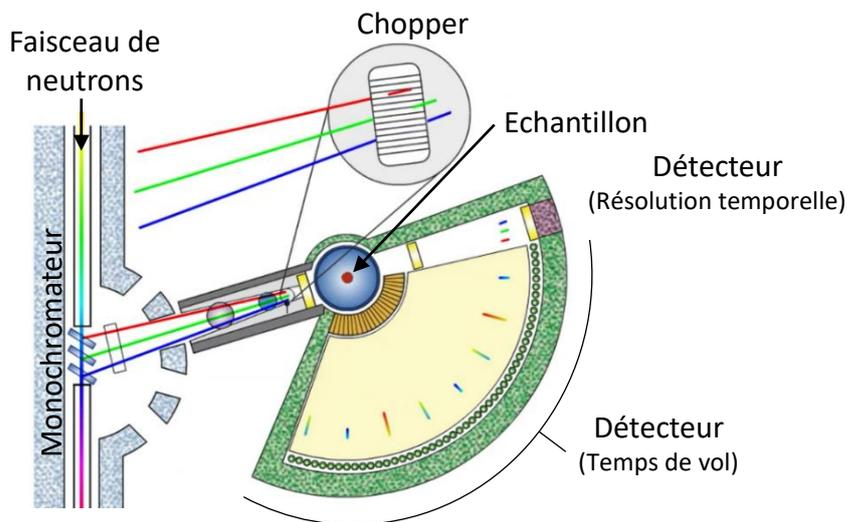
Figure 64 : Schéma du fonctionnement du spectromètre SHARP<sup>7</sup>.
