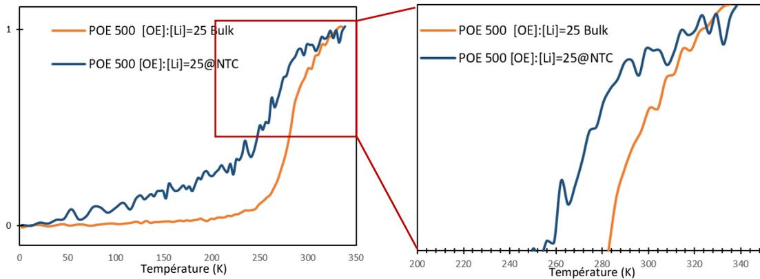
(c) Déplacement carré moyen de (a) normalisé pour POE *bulk* et confiné en fonction de la température.
