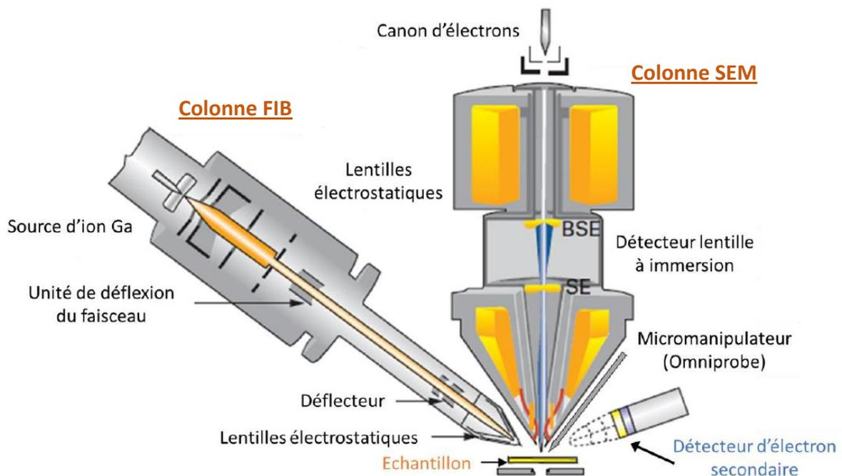
Figure 98 : Représentation schématique du FIB/MEB. (d'après la thèse de Joyce ROQUE)<sup>171</sup>
