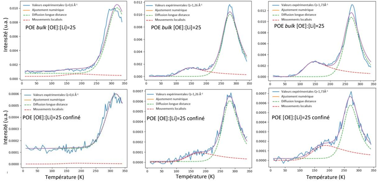
Figure 70 : Courbes IFWS, où le transfert d'énergie est fixé à 2  $\mu\text{m}$  pour différentes valeurs de  $Q$ . Le POE en bulk et POE confiné @NTC sont superposés pour mettre en évidence un décalage en température du phénomène d'activation du processus de diffusion à longue distance
