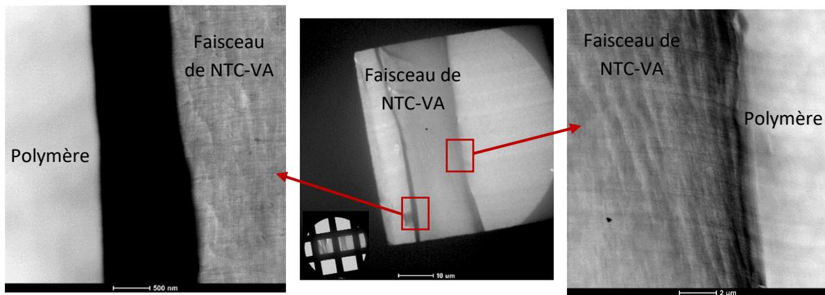
Figure 56 : Images TEM d'un copeau de membrane de NTC-VA, les images de droite et de gauche correspondent aux zones en rouge de l'image centrale.
