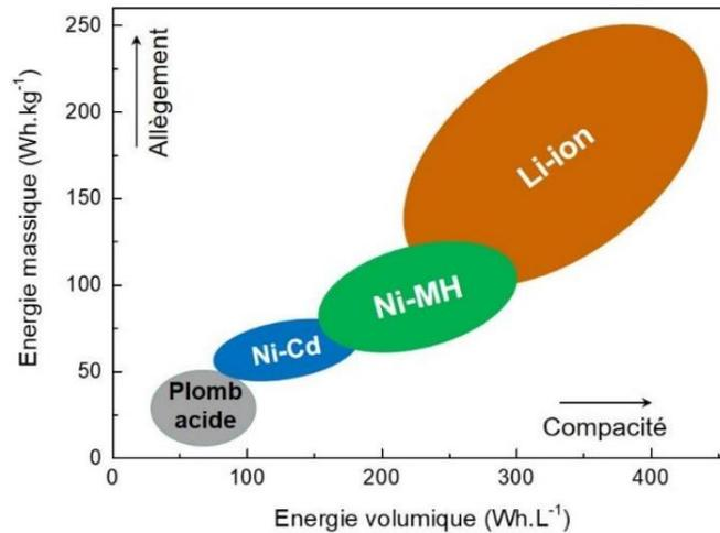
Figure 4 : Densités d'énergie volumiques et massiques des principales familles de batteries à électrolytes aqueux et organique. (d'après Monnier et al.)<sup>7</sup>
