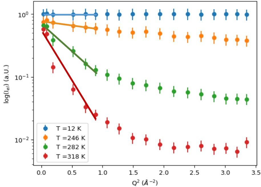
Figure 71 : Courbes de  $\log(S(Q, \omega=0))$  en fonction de  $Q^2$  pour 4 températures différentes pour le POE bulk.
