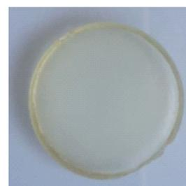
Dans un tube à hémolyse, solubiliser 1w% de DMPA dans le monomère (acrylate ou méthacrylate) puis ajouter l'agent réticulant. Irradier avec lampe UV, 1 W.cm<sup>-2</sup>, 2min.
