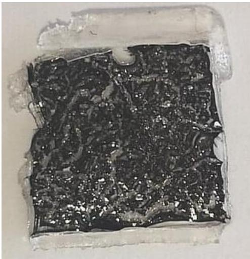
*Figure 41. Photographie de la membrane obtenue par l'imbibition d'épaisseur contrôlée. La matrice de polymère transparente piège les nanotubes de carbone en noir.*
