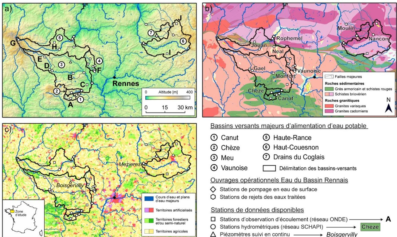
**Figure 2.1.** Localisation des stations de mesures des données hydrologiques disponibles pour les bassins-versants d'alimentation en eau potable principaux d'Eau du Bassin Rennais. En arrière-plan, les caractéristiques principales du milieu : a) topographie (Sources des données : IGN, BD ALTI 75m), b) géologie (Source des données : BRGM, carte au 1 : 1 000 000), c) occupation du sol (Sources des données : CORINE Land Cover 2018).
