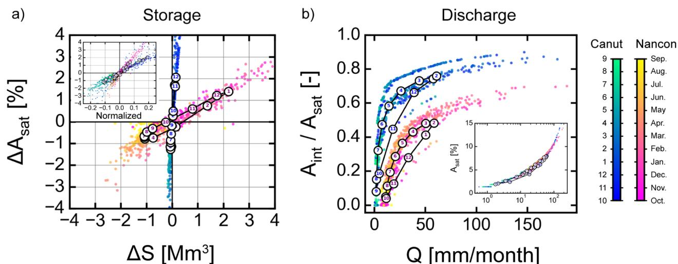
Figure 4.9. a) Variation de la proportion d'aire saturée en eau à la surface  $A_{\text{sat}}$  (réseau hydrographique) à l'échelle du bassin-versant en fonction de la variation du stockage d'eau souterraine (en millions de  $\text{m}^3$  d'eau), pour le bassin-versant du Canut et du Nançon. b) Proportion du réseau hydrographique intermittent sur le réseau hydrographique total  $A_{\text{int}} / A_{\text{sat}}$ , en fonction du débit  $Q$  simulé.
