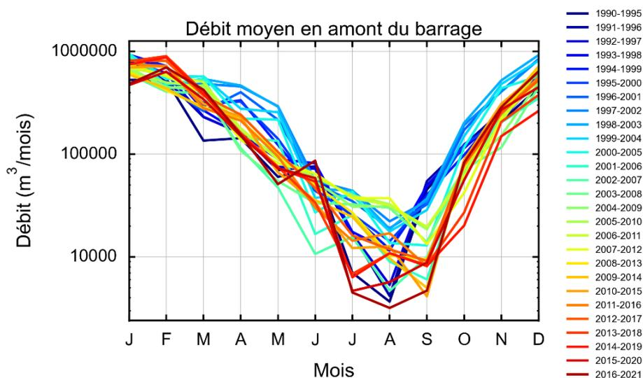
Figure 2.8. Moyenne glissante sur 5 ans de 1990 à 2021 des débits mensuels mesurés à la station hydrométrique située en amont de la retenue de la Chèze. Code station : J736422001.
