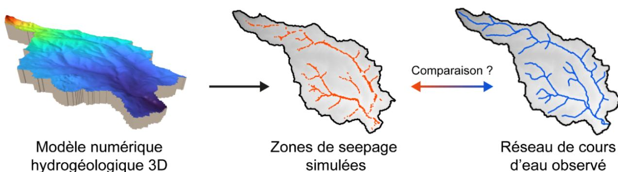
Figure 3.2. Schéma conceptuel illustrant l'idée de calibrer les zones de seepage simulées par un modèle hydrogéologique en le comparant à un réseau hydrographique observé.
