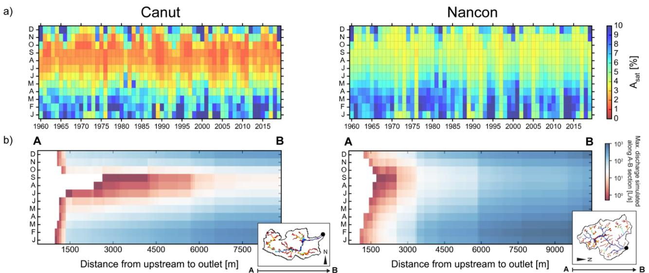
**Figure 4.8.** a) Simulation de la proportion d'aire saturée en eau en surface  $A_{sat}$  (réseau hydrographique) à l'échelle du bassin versant, pour le Canut et le Nançon, de 1960 à 2019, et pour les différents mois de l'année. b) Débit maximal calculé à partir des simulations le long de la section amont-aval des bassins-versants, et moyenné pour chaque mois de l'année de 1960 à 2019.
