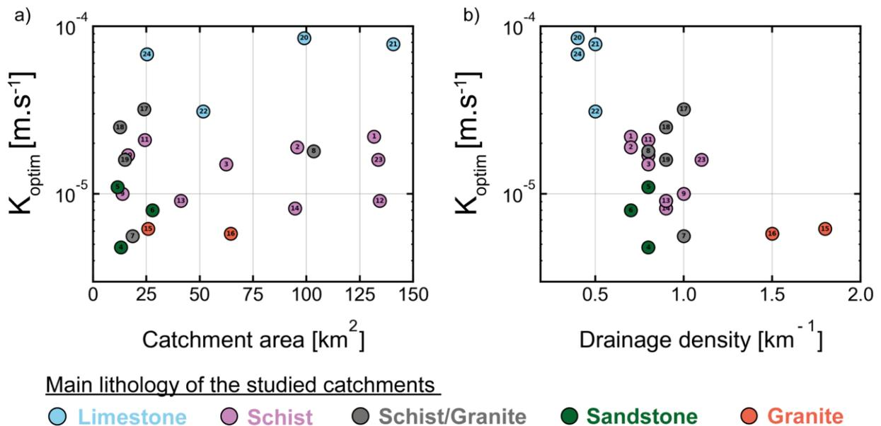
Figure 3.3. Relation entre la conductivité hydraulique estimée  $K_{optim}$  avec a) l'aire des bassins-versants et b) avec la densité de drainage du réseau de cours d'eau observé.
