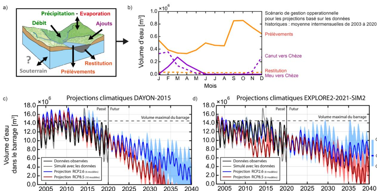
**Figure 5.15.** a) Schéma conceptuel des volumes d'eau en entrée et en sortie du barrage de la Chèze. b) Moyenne intermensuelle historique des volumes d'eau de la partie gestion opérationnelle du barrage : ajouts, prélèvements et restitution. Projections des volumes d'eau dans le barrage de la Chèze jusqu'en 2040, à partir des projections climatiques c) « DAYON-2015 » et d) « EXPLORE2-2021-SIM2 ».
