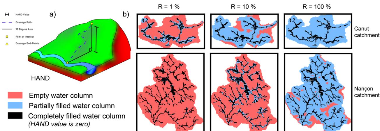
**Figure 4.7.** a) Schéma conceptuel la méthode du "Height Above Nearest Drainage" (HAND). Source : (Scriven et al., 2021). b) Cartographies des cellules entièrement saturées en eau ou non, basé sur l'approche du HAND et la porosité de l'aquifère, pour différents taux de recharge.
