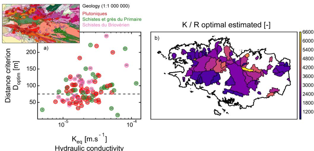
**Figure 6.2.** Déploiement à l'échelle régionale de la méthode d'estimation de la conductivité hydraulique  $K_{eq}$  à partir du réseau hydrographique sur la base de modélisation hydrogéologique. a) Résultats obtenus par type de lithologie dominante et b) cartographie du K/R optimal estimé pour chaque bassin-versant.
