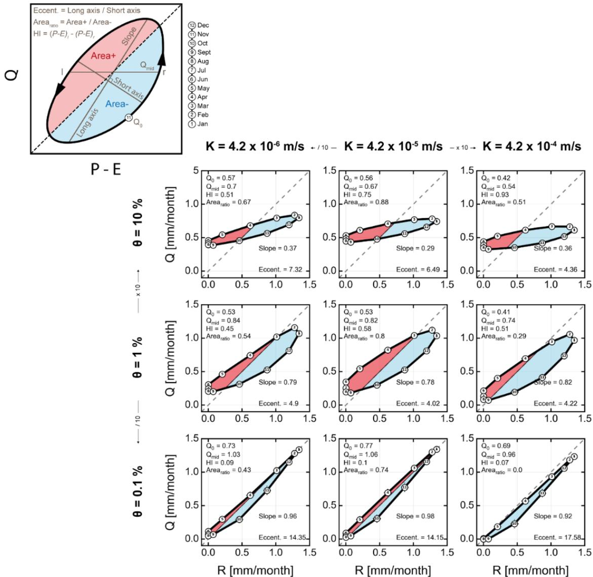
Figure 4.5. Simulation des débits à partir du modèle hydrogéologique représentés en fonction de la recharge. Pour chaque cas, quelques indicateurs de la boucle d'hystérésis de la relation recharge-débit sont calculés sur la base du schéma conceptuel en haut à gauche des résultats.
