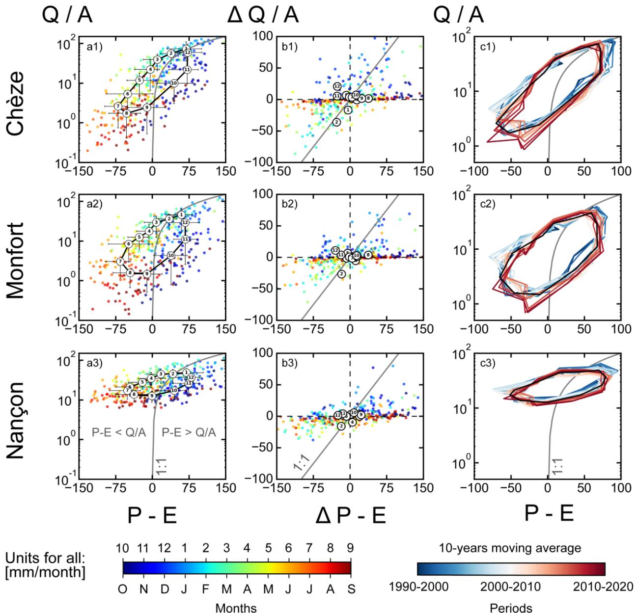
Figure 2.24. Relations des précipitations efficaces ( $P-E$ ) avec le débit spécifique ( $Q/A$ ) pour 3 stations hydrométriques aux bassins versants de types lithologiques différents (Chèze : type grès et schiste, Monfort : type schiste, Nançon : type granite). a1 à a3) Boucles d'hystérésis observées. b1 à b3) Variation dans le temps (delta  $\Delta$ ) de la relation. c1 à c3) Moyenne glissante sur 10 ans des boucles d'hystérésis intermensuelles de 1990 à 2019.
