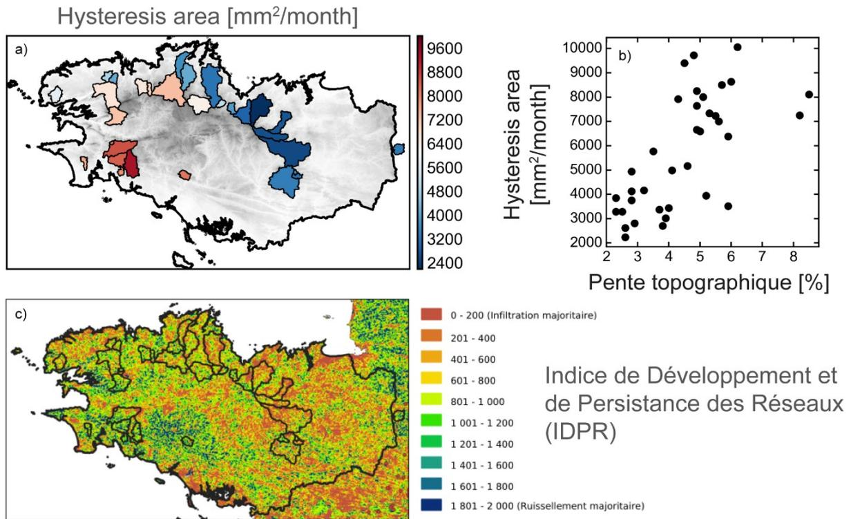
**Annexe 16. a) Aire de l'hystérésis observée de la relation P-E versus Q/A calculée pour une quarantaine de bassins-versants. b) Au premier ordre, cette aire d'hystérésis semble plutôt liée à la moyenne de la pente topographique du bassin-versant. c) Ces analyses pourront être comparées à l'IDPR, indicateur fortement lié à la densité de drainage du réseau hydrographique en surface.**
