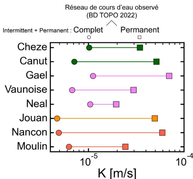
Figure 5.2. Pour les 8 sous-bassins-versants calibrés sur le débit, résultats de l'estimation de la conductivité hydraulique à partir du réseau hydrographique observé : permanent et complet (permanent et intermittent) (BD TOPO, IGN (2022)). Les couleurs font références à la géologie des bassins-versants (Figure 5.1).
