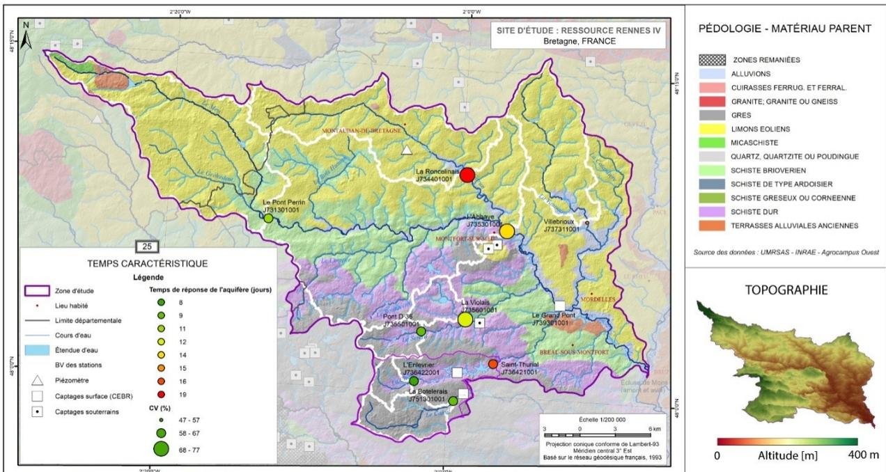
Figure 2.20. Moyennes et coefficients de variation des temps de réponses estimés, à partir de l'analyse de récession des débits mesurés, pour l'ensemble des stations hydrométriques du bassin versant du Meu et du Canut.
