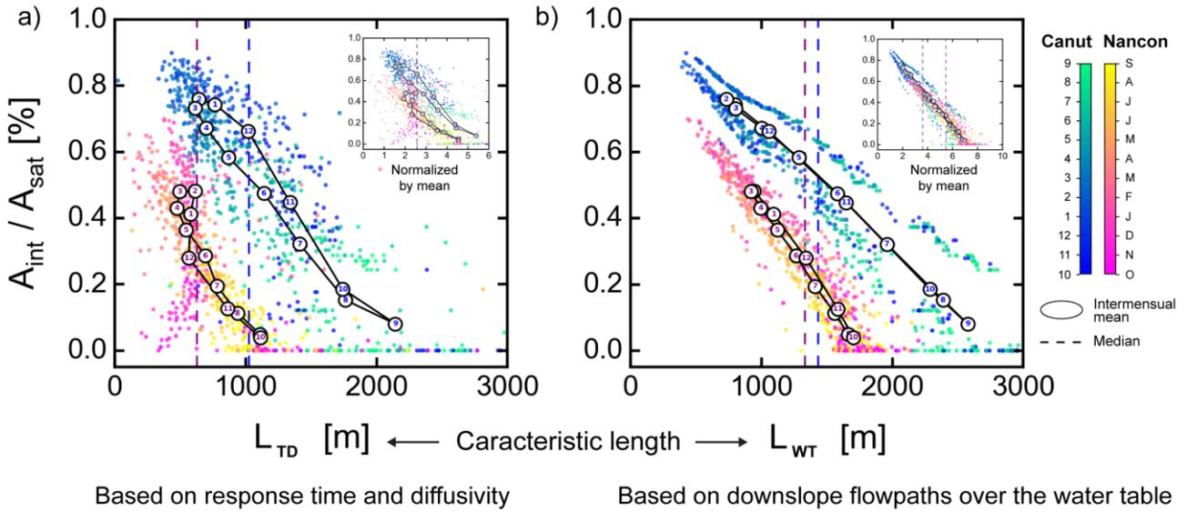
**Figure 4.10.** Proportion du réseau hydrographique intermittent sur le réseau hydrographique total  $A_{int} / A_{sat}$ , à l'échelle des bassins-versants du Canut et du Nançon, en fonction des longueurs caractéristiques estimées a) à partir de la diffusivité et des temps de réponse simulés, et b) à partir du calcul des distances d'écoulement entre les cellules de la topographie de la nappe simulée, jusqu'aux cellules du réseau hydrographique simulé le plus proche.
