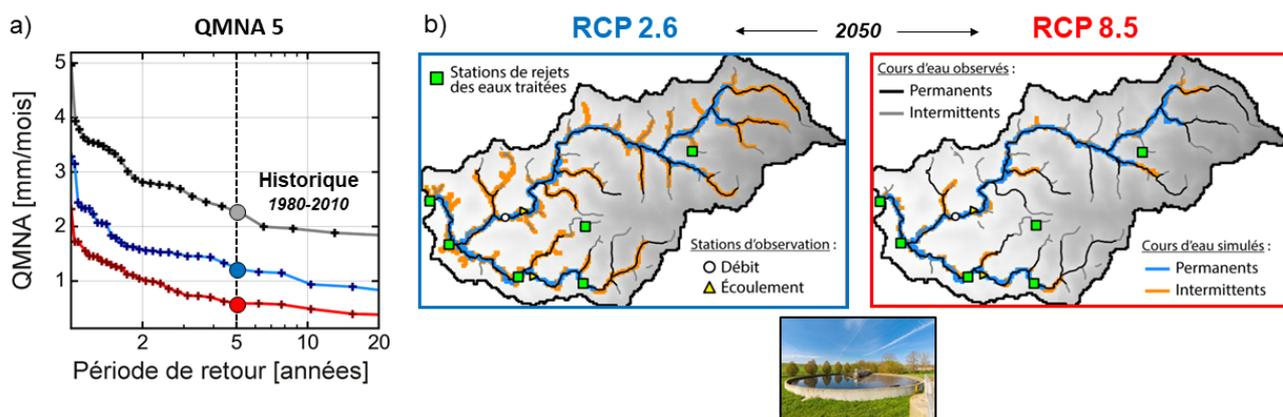
**Figure 5.16.** a) Projection à l'horizon 2040-2070 du QMNA à l'exutoire du bassin-versant de la Vaunoise (nord-ouest de Rennes) en fonction de la période de retour associée. b) Cartographie des cours d'eau permanents et intermittents, ici à titre d'exemple pour l'année 2050. Données climatiques utilisées : moyenne de l'ensemble des projections multi-modèles « DAYON-2015 », scénario RCP2.6 et RCP8.5.
