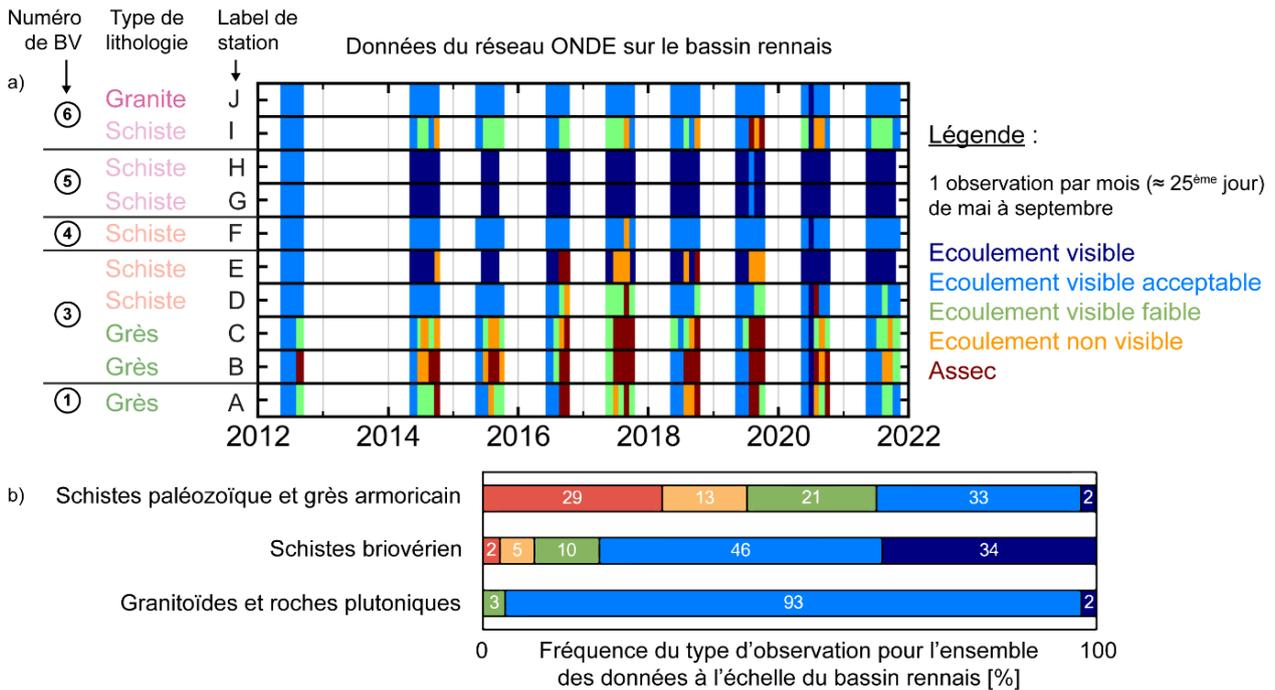
**Figure 2.21.** a) Données d'observations visuelles sur l'état d'écoulement des cours d'eau (réseau ONDE) pendant la période de basses eaux, pour l'ensemble des stations localisées sur les bassins-versants étudiés. Numéro de BV à retrouver sur la Figure 2.1. b) Pour l'ensemble des observations des stations, fréquence en [%] du type d'écoulement observé en fonction de la lithologie dominante du bassin-versant.
