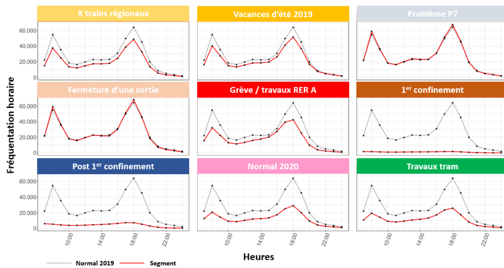
FIGURE 4.8 – Profils typiques des flux totaux obtenus dans chaque segment s . Chaque profil est comparé à celui de Normal 2019 , c'est-à-dire le segment de référence (en gris).
