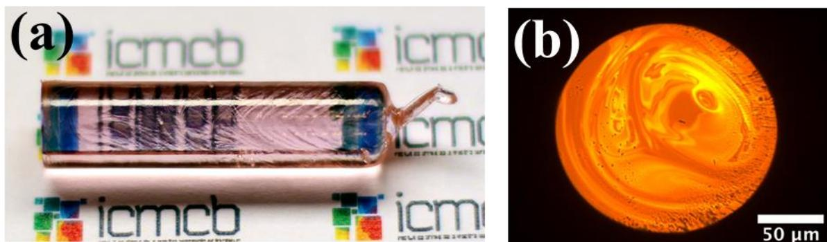
**Figure 29:** (a) Préforme gallates co – dopée aux ions  $\text{Er}^{3+}/\text{Yb}^{3+}$  correspondant à la composition de cœur et (b) section transverse de la fibre optique obtenue.
