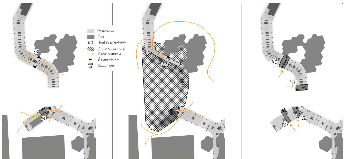
Figure 25 : Schéma de situation des cheminements pour accéder aux entrées et montées des 40 et 50 Arlequin : avant les travaux (gauche), pendant les travaux avec l'enclos de chantier (milieu), et après les travaux (droite), 2015-2020.
