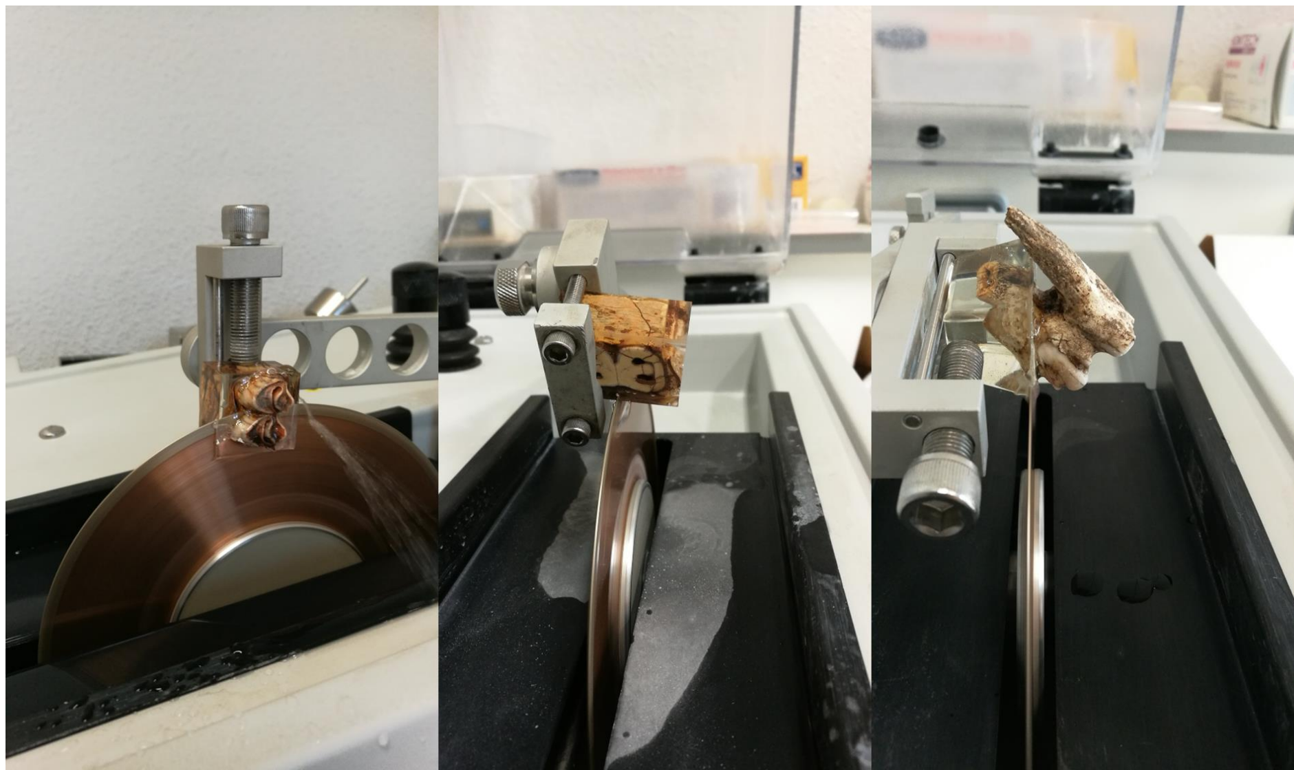
Figure 20 : Scie à rotation lente : séparation de la couronne puis des deux racines d'une molaire de cerf (gauche). Prélèvement ciblé d'une racine de bison (droite).
