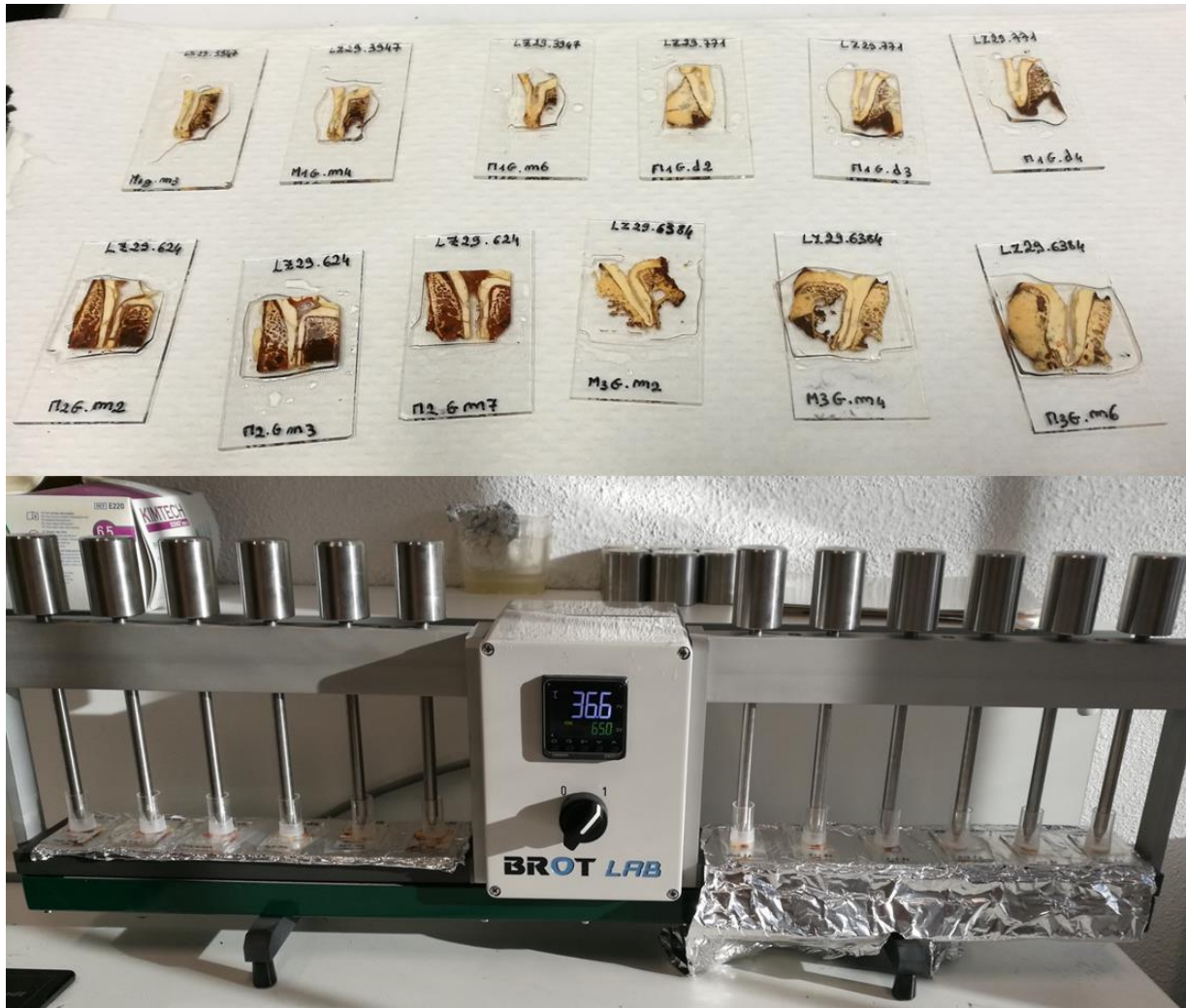
Figure 22 : Section collées sur les lames minces en verre annotées (haut). Phase de polymérisation sous chauffe-presse (bas).
