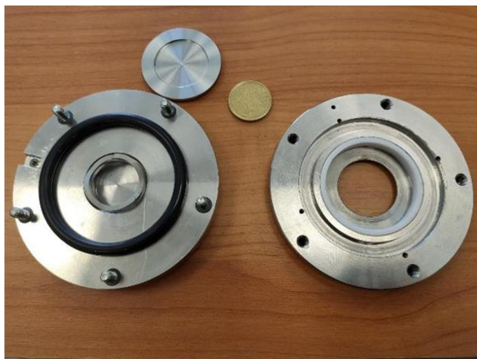
Figure 0-4 Vue explosée et photo d'un prototype en inox de la cellule électrochimique conçu dans l'objectif de réaliser des analyses operando XRD sur notre Rigaku SmartLab.
