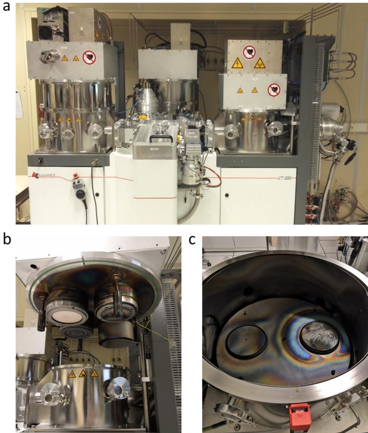
Figure 2-4 : Photo du bâti de pulvérisation cathodique magnétron Alliance concept CT200 de l'IEMN en a. Photos de la chambre P2 ouverte pendant une opération de maintenance, les 4 cibles fixées sont visibles en b, les postes chaud et froid à l'intérieur de la chambre sont visibles en c.
