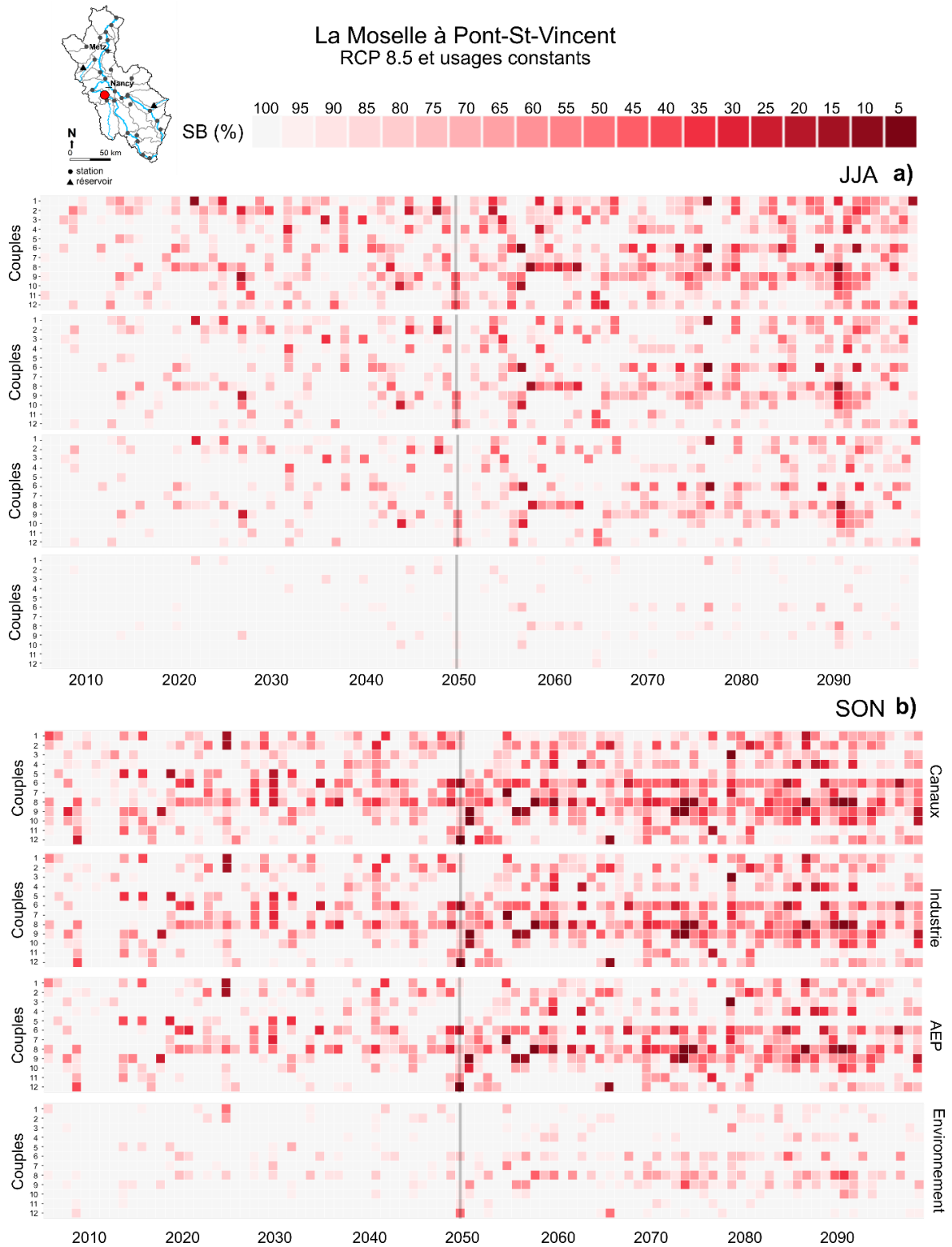
Figure 6.14 : Évolution de la satisfaction des besoins (usages constants dans le futur) en eau sur le bassin de la Moselle à Pont St-Vincent. a) en été (JJA), b) en automne (SON) pour le RCP 8.5. Numérotation des couples GCMs/RCMs dans l'ordre : (1) NorESM1-M_REMO2015, (2) NorESM1-M_HIRHAM5, (3) MPI-ESM-LR_REMO2009, (4) MPI-ESM-LR_CCLM4-8-17, (5) IPSL-CM5A-MR_WRF381P, (6) IPSL-CM5A-MR_RCA4, (7) HadGEM2-ES_RegCM4-6, (8) HadGEM2-ES_CCLM4-8-17, (9) EC-EARTH_RCA4, (10) EC-EARTH_RACMO22E, (11) CNRM-CM5-LR_RACMO22E, (12) CNRM-CM5-LR_ALADIN63
