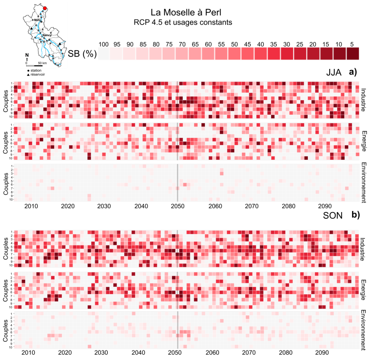
Figure 6.17 Évolution de la satisfaction des besoins (usages constants dans le futur) en eau sur le bassin de la Moselle à Perl. a) en été (JJA), b) en automne (SON) pour le RCP 4.5. Numérotation des couples GCMs/RCMs dans l'ordre : (1) NorESM1-M_HIRHAM5, (2) MPI-ESM-LR_REMO2009, (3) MPI-ESM-LR_CCLM4-8-17, (4) IPSL-CM5A-MR_WRF381P, (5) IPSL-CM5A-MR_RCA4, (6) HadGEM2-ES_CCLM4-8-17, (7) EC-EARTH_RCA4, (8) EC-EARTH_RACMO22E, (9) CNRM-CM5-LR_RACMO22E, (10) CNRM-CM5-LR_ALADIN63.
