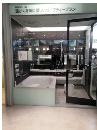
Figure 4 : proposition d'aménagement de salle de bains dans une salle d'exposition de l'entreprise Lixil. La baignoire est basse et une main-courante est installée.
