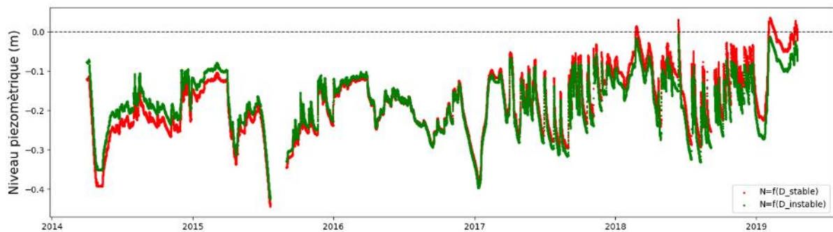
Figure 18 Comparaison des corrections de niveau piézométrique pour un piézomètre instable. La série temporelle verte (correcte) est calculée avec une distance sol-obturateur variable, la série temporelle rouge (incorrecte) est calculée avec une distance sol-obturateur fixe (utilisée pour un piézomètre stable).
